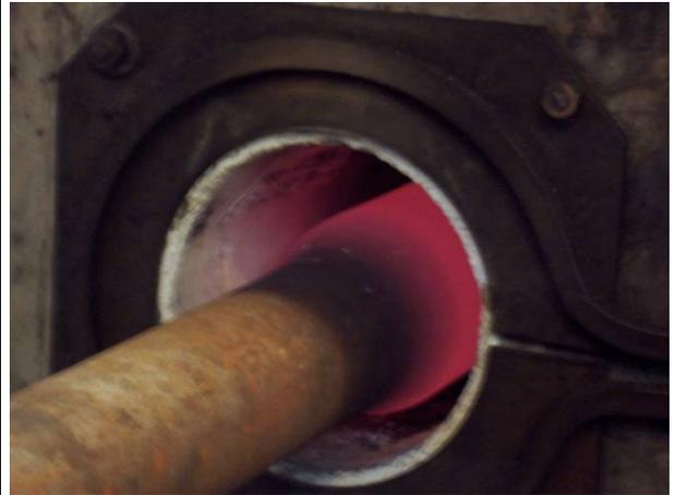
Figura AII-36 – Registro fotográfico tratamiento de revenido de recalques en PEMA.
