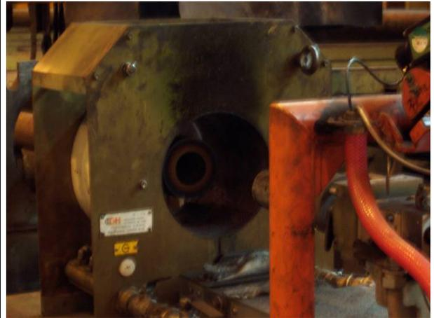
Figura AII-39 – Registro fotográfico tratamiento de revenido de recalques en SWA3.
