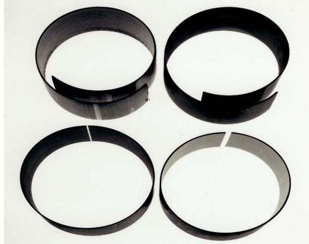
**Figura 29:** Evidencia de las tensiones residuales.
