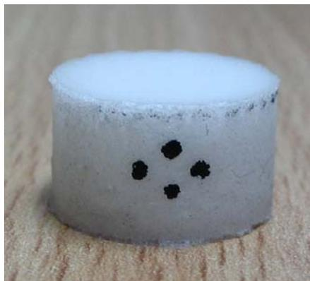
**Figura 15:** Configuración de puntos para la determinación del coeficiente de Poisson.
