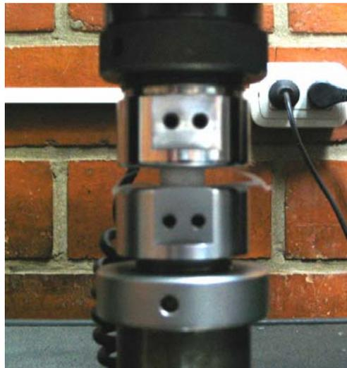
**Figura 12:** Configuración de las mordazas empleadas en el ensayo de compresión uniaxial
