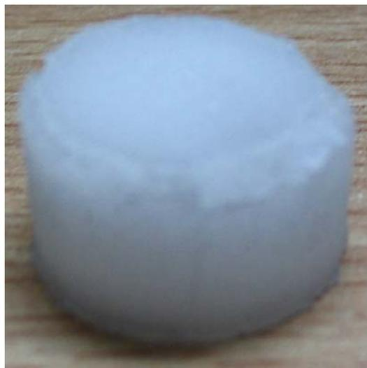
**Figura 42:** Probeta rota en ensayo de compresión confinada (invertida para facilitar su visualización)
