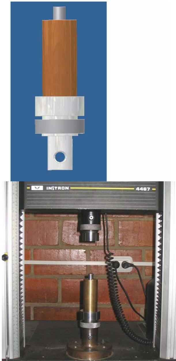
**Figura 16:** Dispositivo construido para el ensayo de compresión confinada y su ubicación en la máquina de ensayos
