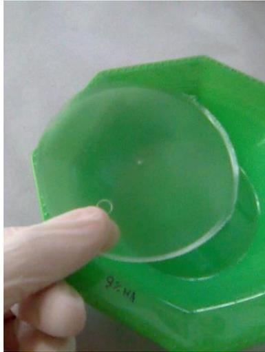
**Figura 27.** Film de hidrogel de PVA/HA obtenido por el método de C/D.
