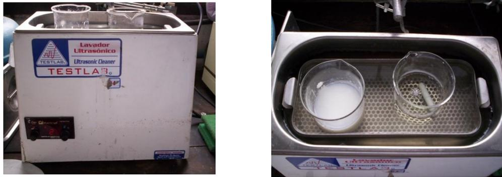
**Figura 24.** Disminución del contenido de burbujas mediante baño ultrasónico.
