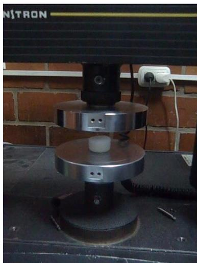
**Figura 34.** Platos utilizados en el ensayo de compresión.
