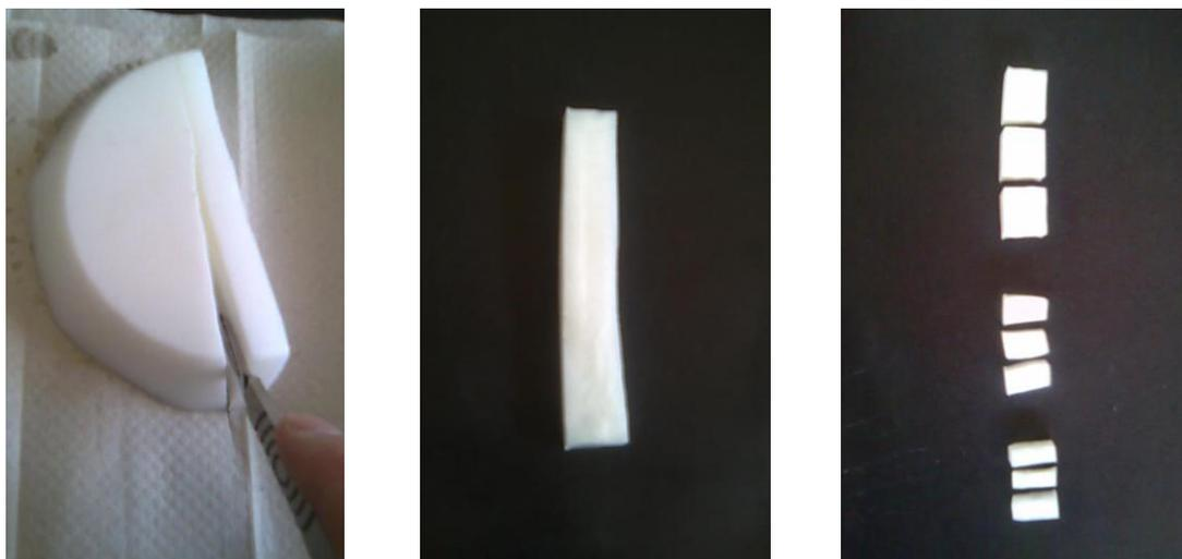
**Figura 33.** Corte de muestras para el ensayo de absorción de hidrogeles.
