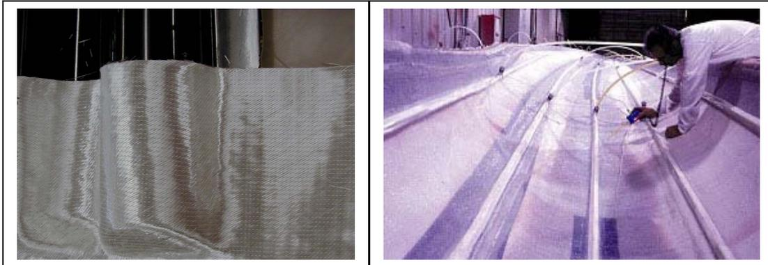
Figura 1.12 – Procesamiento de una pala de molino eólico por infusión en vacío –
