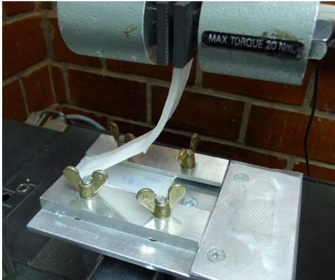
Figura 57. Ensayo de peeling de la probeta 2B17
