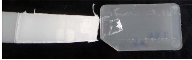
Figura 24 Probeta de la mezcla #2 inyectada a 200°C con molde a 40°C, después del peeling.
