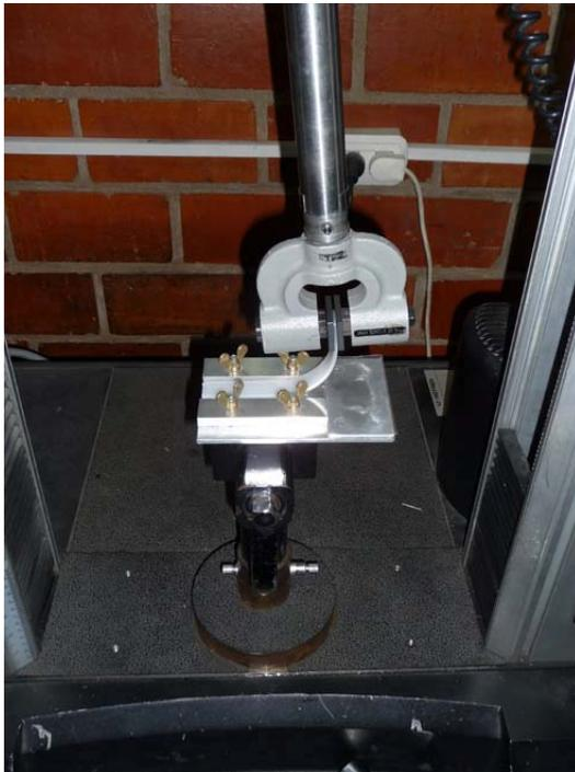
Figura 12 Ensayo de peeling sobre una probeta inyectada
