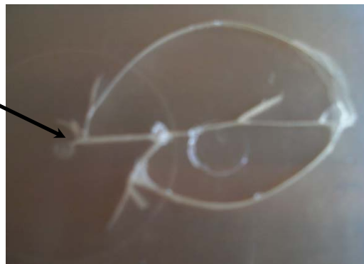
Figura 7.37. Muestras de PP-2 impactadas en la zona PI.
