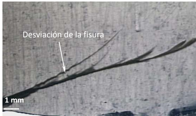
Figura 7.61. Vista lateral de un espécimen de PP tomado de la zona PI mostrando el camino de propagación de la fisura.
