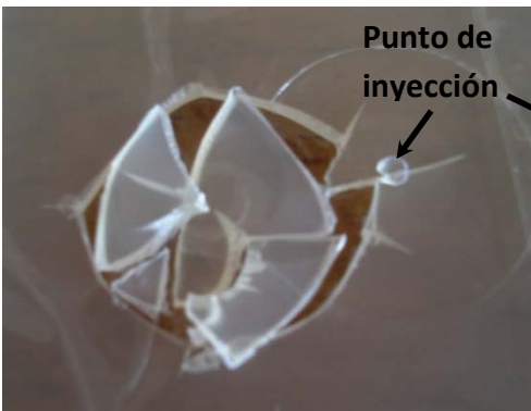
Figura 7.37. Muestras de PP-2 impactadas en la zona PI.
