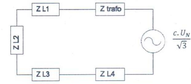
Figura 6.9 Circuito equivalente
