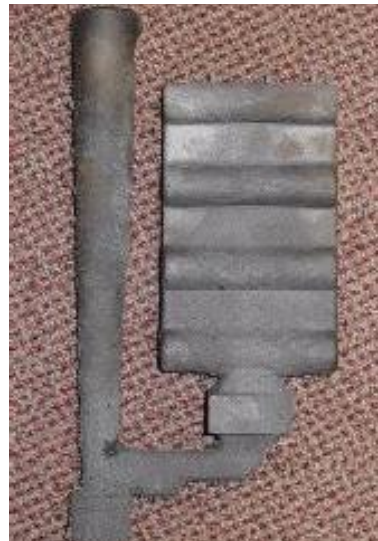
Figura 1. 30 Modelo utilizado para colar placas de fundición nodular de pequeño espesor 33 y 34
