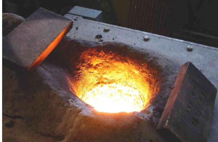
Figura 3. 2 Crisol del horno durante la fusión del metal.
