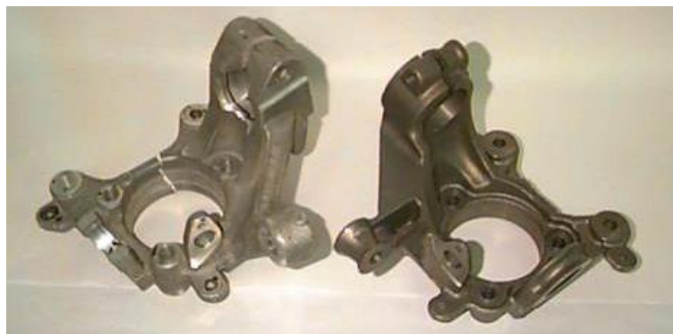
Figura 1. 28 Pieza de aluminio y su potencial reemplazo en fundición de hierro de espesor delgado y bajo peso.
