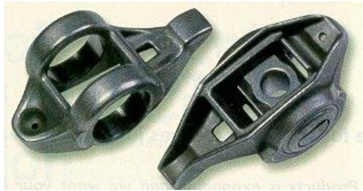
Figura 1. 26 Botadores fabricados en fundición nodular de pequeño espesor producidas en grandes volúmenes utilizando moldes de arena (proceso shell) y colado contra gravedad.
