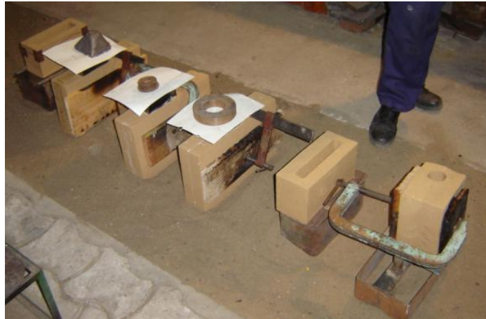
Figura 3. 5 Moldes verticales y bloques “Y” de ½” momentos antes de la colada.
