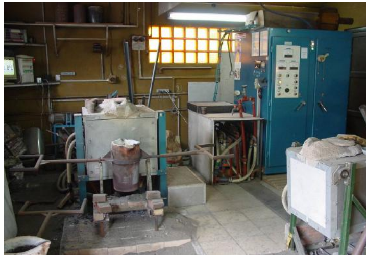
Figura 3. 1 Imagen de la unidad de potencia y del crisol del horno de inducción, con cuchara de colada el pie del horno.
