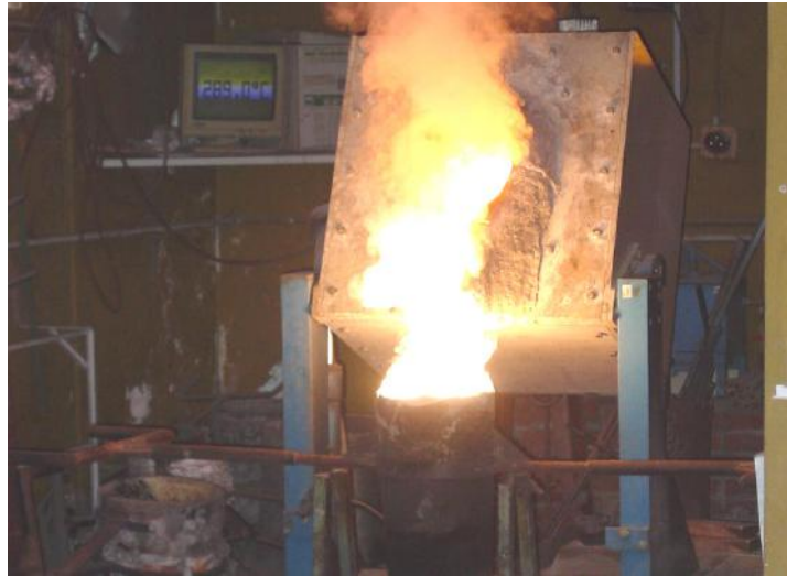
Figura 3. 4 Cuchara al pie del horno durante el tratamiento de nodulización con FeSi6Mg.
