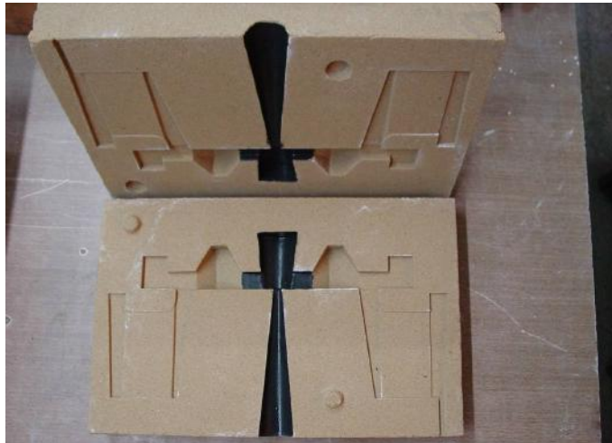
Figura 4. 11 Molde de arena producido a partir de la placa modelo de placas verticales, listo para ser cerrado.
