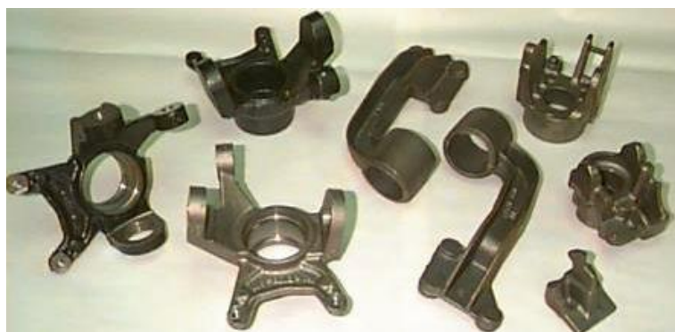
Figura 1. 23 Piezas de fundición nodular de pequeño espesor fabricadas por moldeo en verde.
