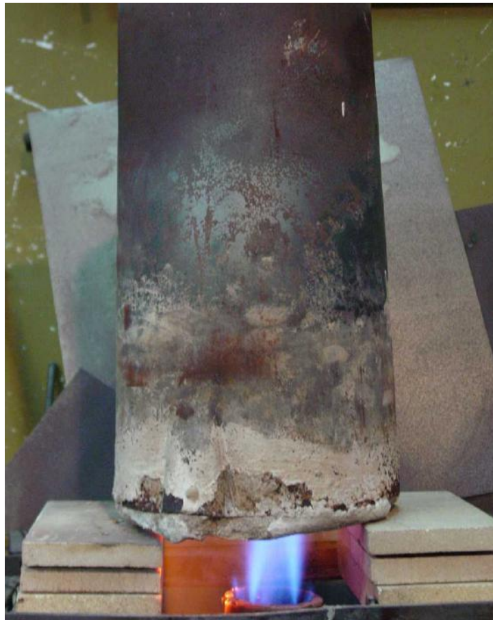
Figura 3. 3 Calentamiento de la cuchara en el precalentador.
