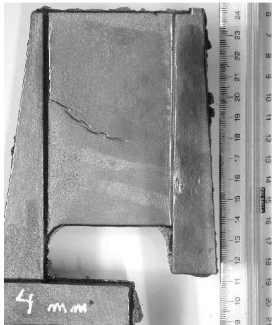
Figura 4. 23 Placa de 4 mm de espesor colada con el molde vertical, mostrando defectos superficiales. La escala permite apreciar las dimensiones.
