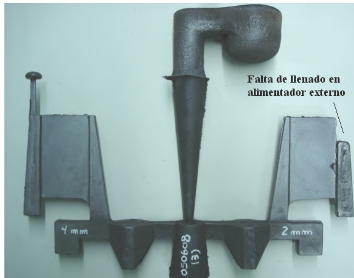
Figura 7. 21 Pieza colada en el molde vertical con defectos de llenado en el alimentador exterior de la placa de 2 mm de espesor (Colada BS, 4.15 % de C.E).
