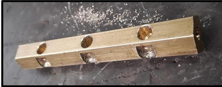
Figura 5.4, Imagen del porta-probetas terminado.
