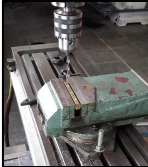
Figura 5.2, Imagen tomada luego de haber hecho los asientos para las probetas.
