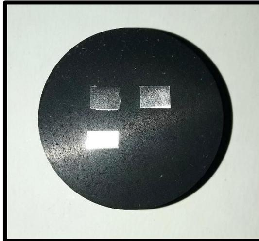
Figura 5.15, Disco con las muestras A1, C3 y electrodo 1 incluidos.
