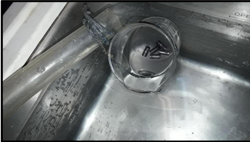
Figura 5.12, Lavado realizado con ultrasonido con agua destilada.
