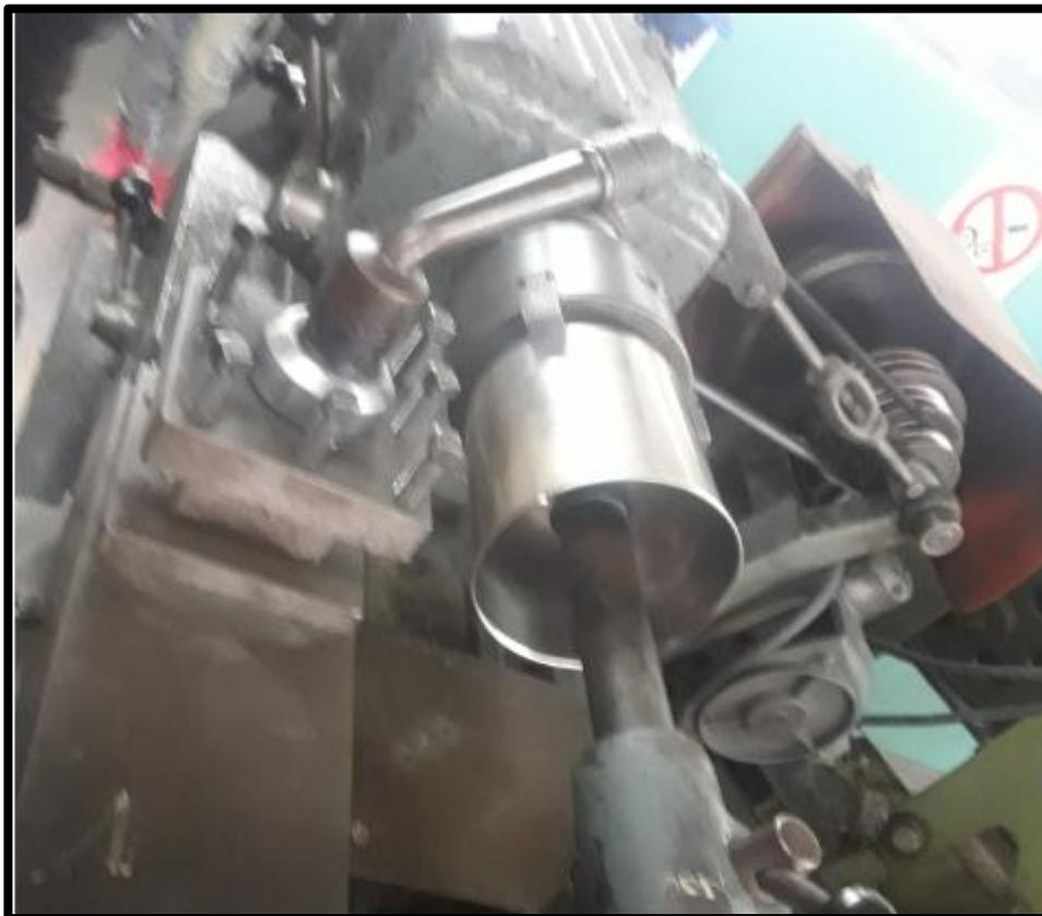
Figura 5.5, Disposición del recipiente para realizar el primer corte.
