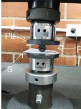
**Figura 2.5** Configuración para ensayo de compresión diametral (P:probeta; S: separadores; PL: platos).
