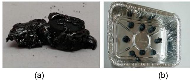
**Figura 3.8** Probetas de mezcla ER: (a) Espumada (b) Menor grado de espumado.
