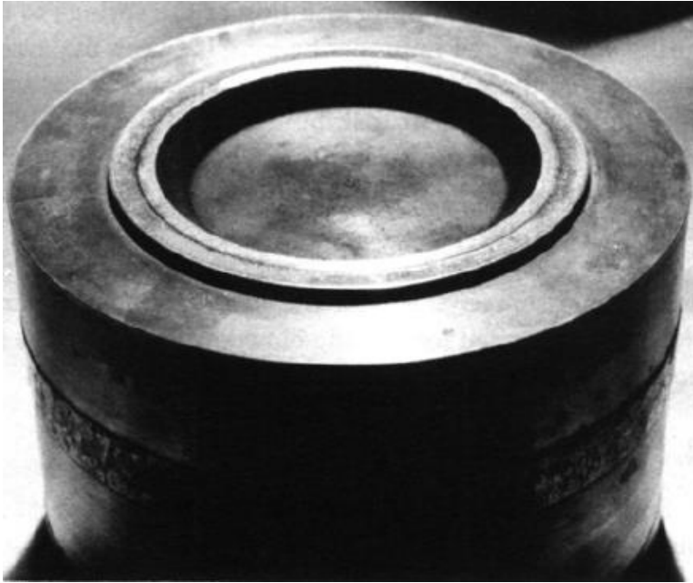
Figura 5-5 Superficie del disco deformada
