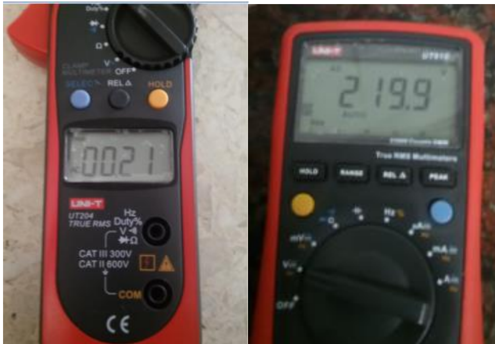
Figura 4.33 Pinza amperométrica y Tester utilizados
