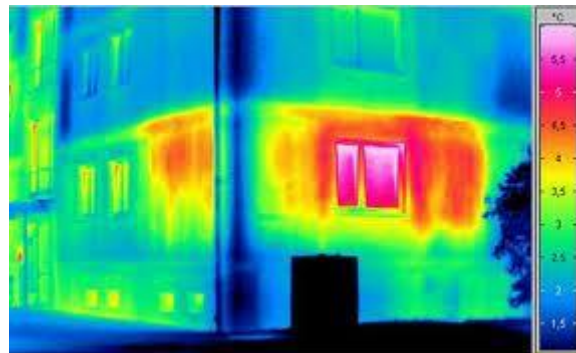
Figura 2.19. Termografía de una ventana
