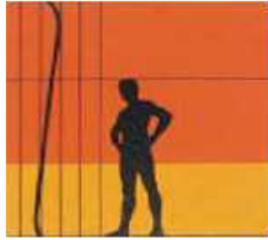
Figura 2.9. Perfil térmico por radiadores:
