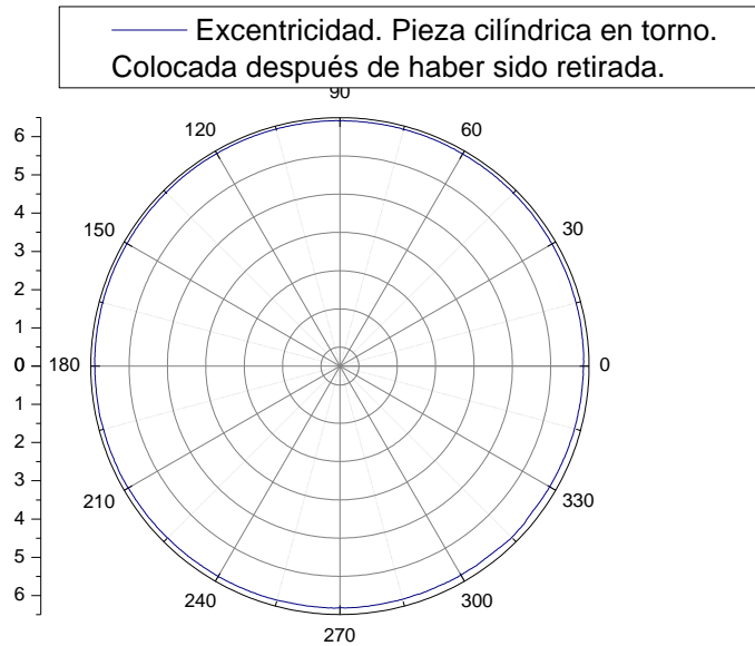
FIGURA 5.15.a. Representación del perfil de la pieza obtenida según el registro anterior (figura 5.12).
