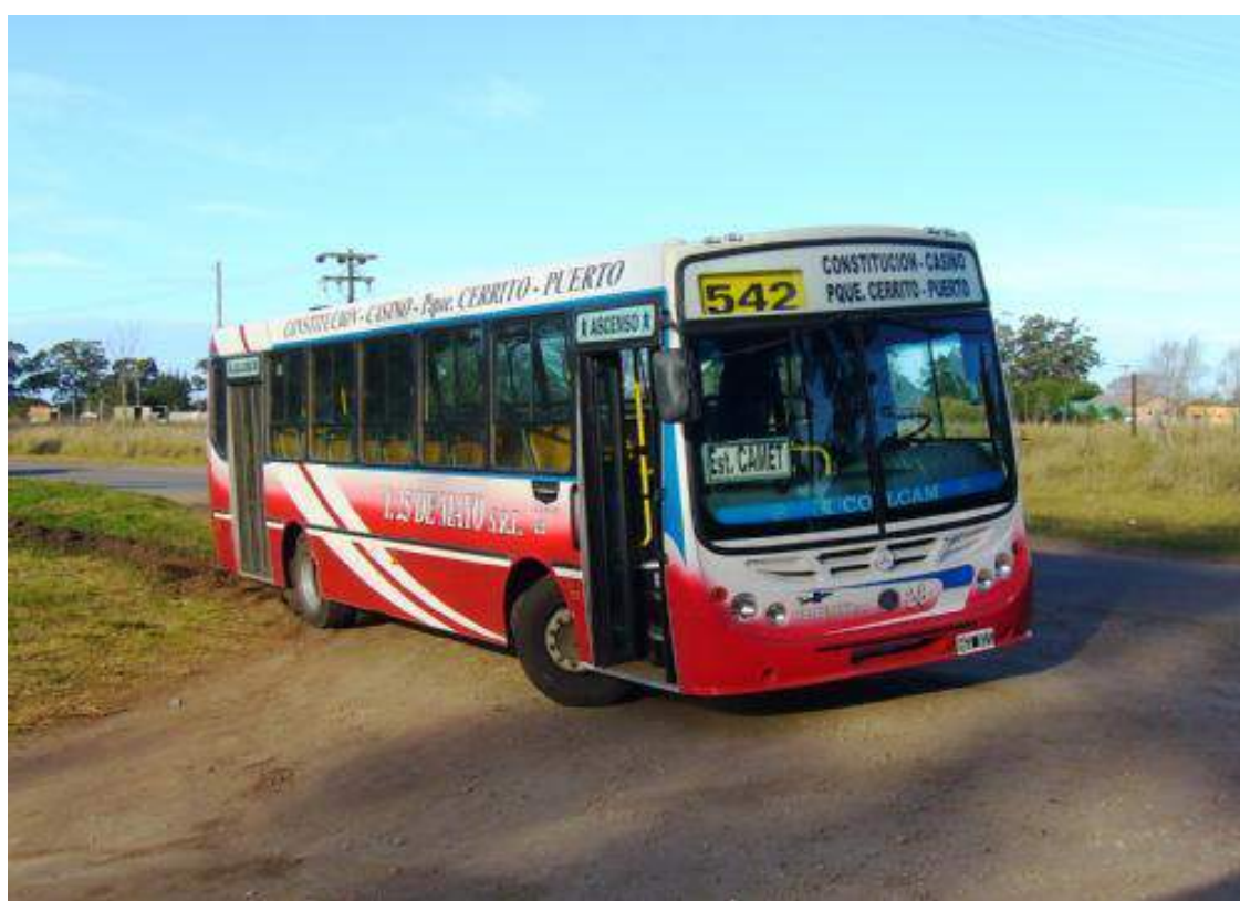
Figura 3.5.1– Colectivo de línea 542, Mercedes Benz OF 1418.
