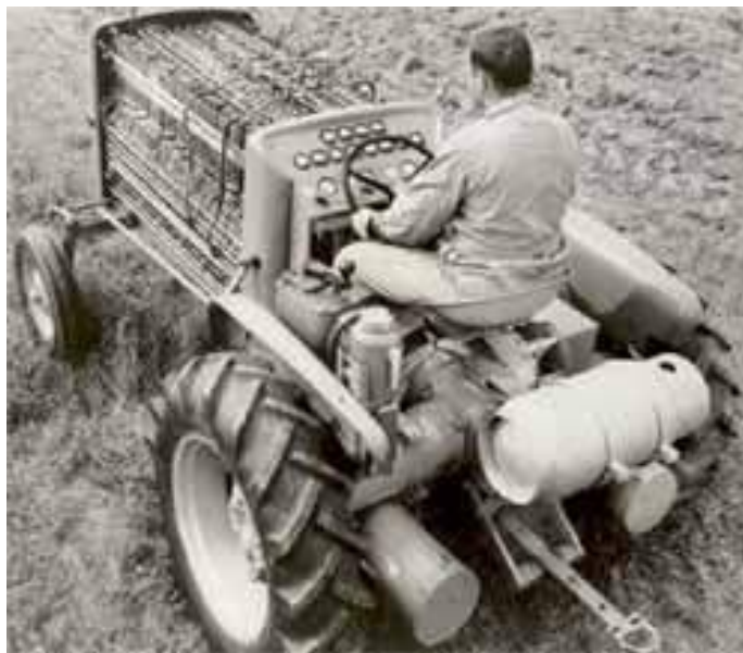
Figura 2.1.2– El tractor experimental de Allis-Chalmers, utilizaba como combustible una mezcla de gases, principalmente propano y oxígeno.
