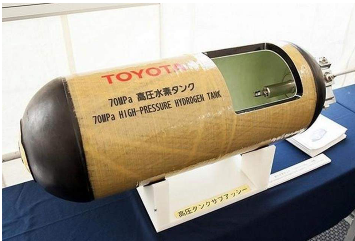
Figura 1.5.1.1 Tanque de almacenamiento de hidrógeno gaseoso utilizado en vehículos.
