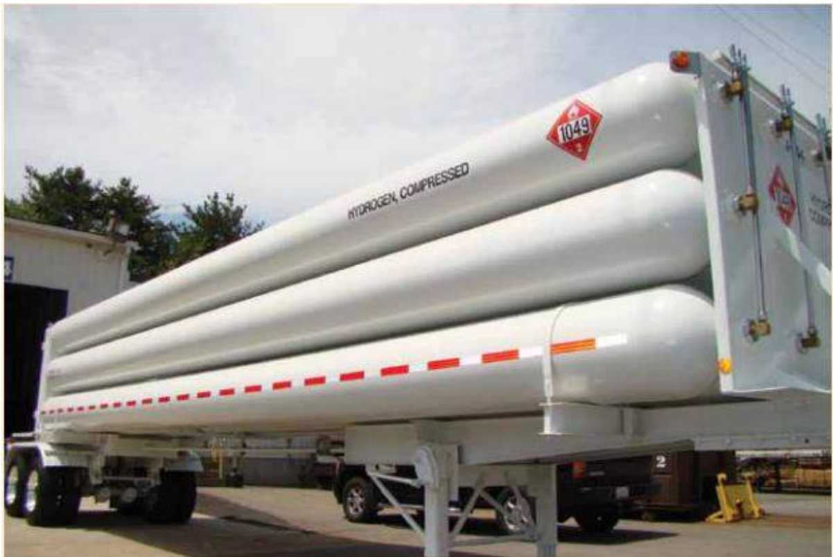
Figura 1.5.1.3 Acoplado con tubos para transporte de hidrógeno gaseoso.
