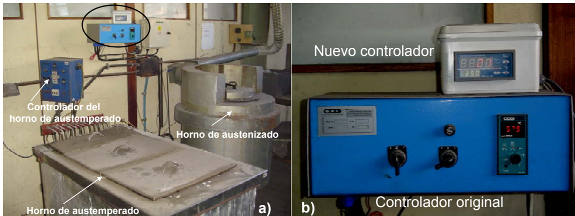
Figura 2.5. a) Hornos de sales utilizados para realizar los tratamientos térmicos. b) Ampliación de la zona encerrada en el círculo, que muestra la incorporación del nuevo controlador, conectado en serie con el original.
