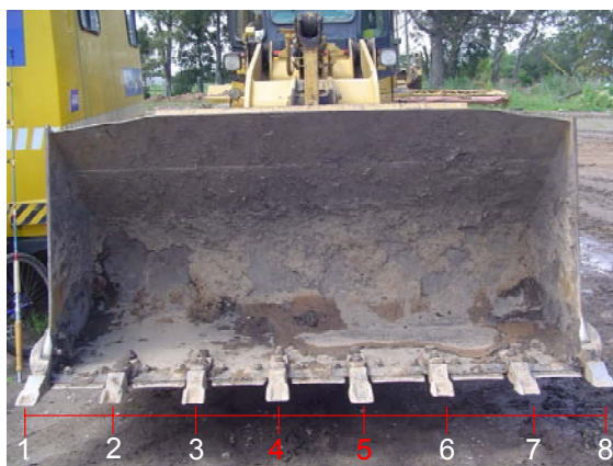
Figura 2.9. Se muestra el balde de la máquina y la numeración de las posiciones de las uñas. En rojo se muestran las posiciones utilizadas para realizar los ensayos.
