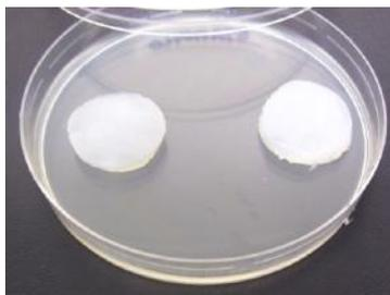
**Figura IV.7.** Ensayo de penetración microbiana (día cero).
