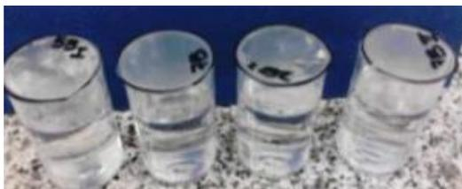
**Figura IV.6.** Ensayos para la determinación de la *WVTR*
