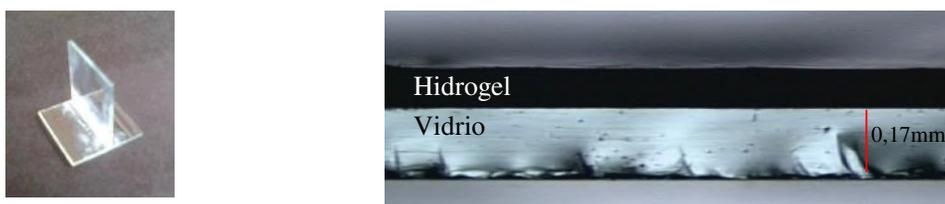
**Figura II.4.** Medición de espesor. Soporte de vidrio (izquierda) y foto obtenida en la lupa (derecha).
