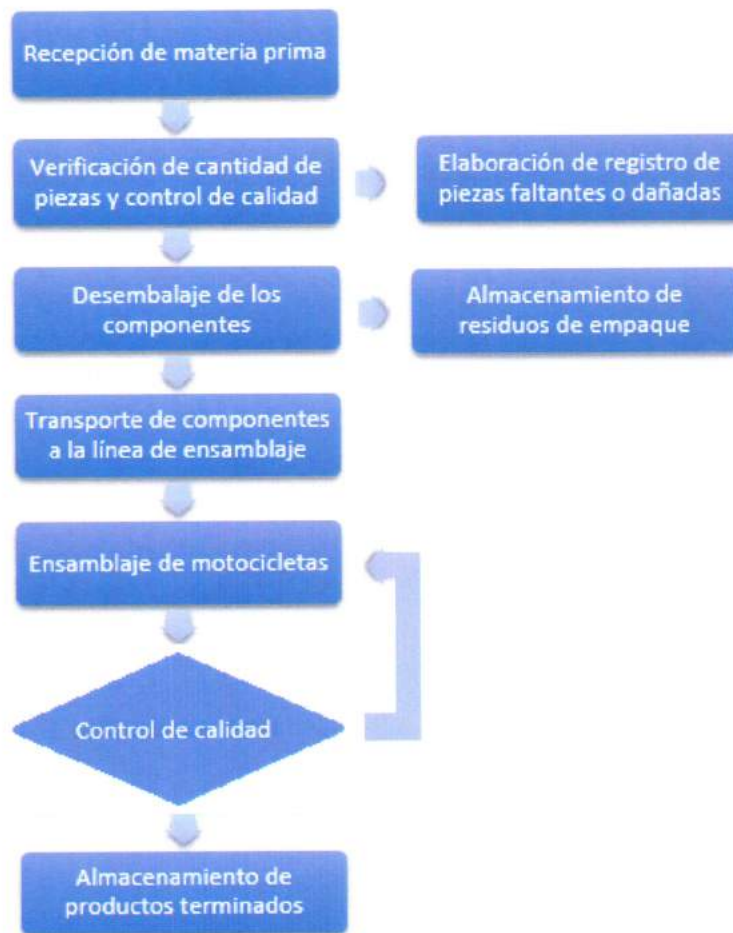
Figura 5: Diagrama de flujo del proceso de ensamblaje Fuente: Elaboración propia
