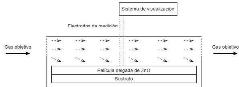
Figura 2.7. Esquema de un detector de gas.
