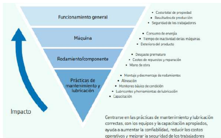
Figura 86: importancia de lubricación, fuente SKF
