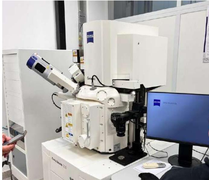
Figura 14. Equipo SEM-Crossbeam 350.
