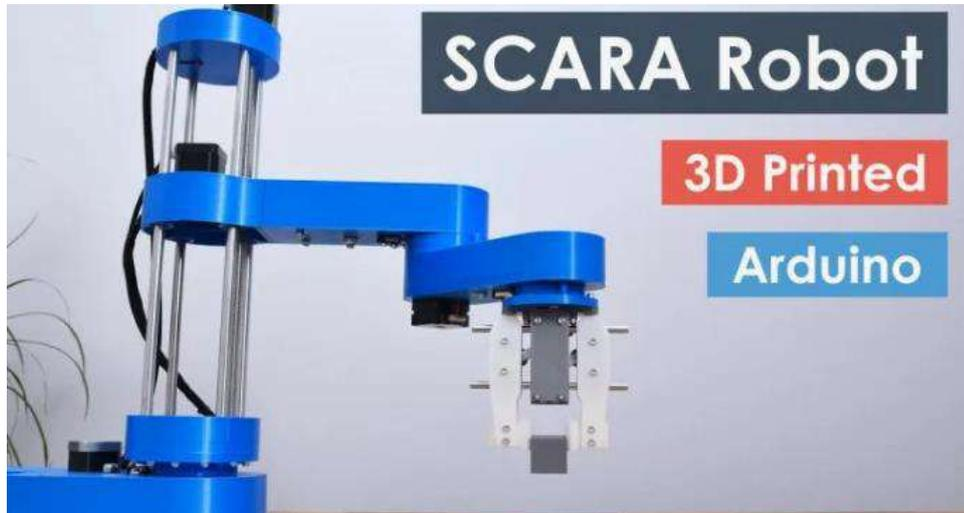
Figura 13. Robot SCARA en impresión 3D. Fuente: [15].
