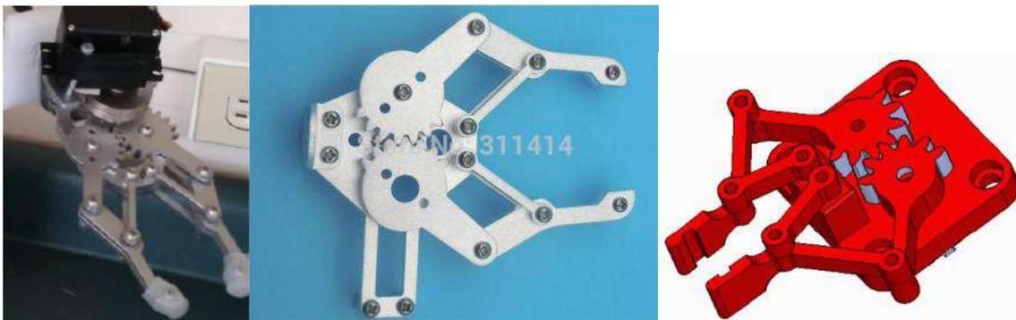
**Figura 21. Imágenes de pinza comúnmente utilizada en robots SCARA. Fuente: [16] [17] [18].**
