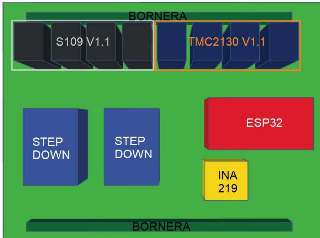
Figura 188. Posición estimada de componentes en PCB. Fuente: elaboración propia.
