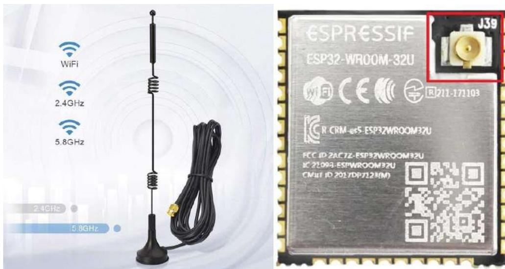
Figura 186. Antena WIFI y lugar de conexión. Fuente: [54] [55].
