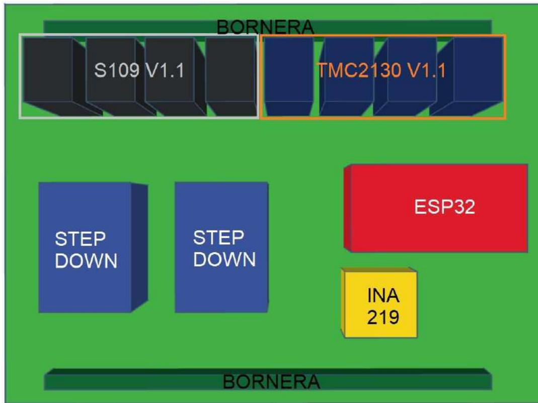
Figura 196. P.C.B. y ubicacion de componentes electronicos. Fuente: elaboración propia.
