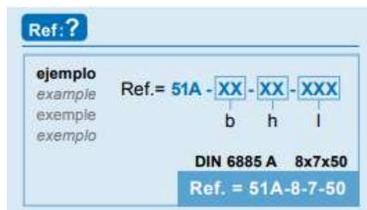
Figura 108. Ejemplo de referencia de pedido dado por el fabricante. Fuente: [35].
