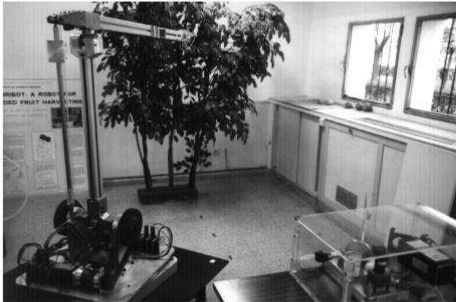
Figura 1. *Agribot*, un robot para la recogida selectiva de cítricos. Fuente: [6].
