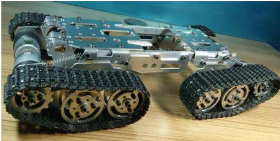
Figura 62. Sistemas de ruedas con orugas. Fuente: [24].
