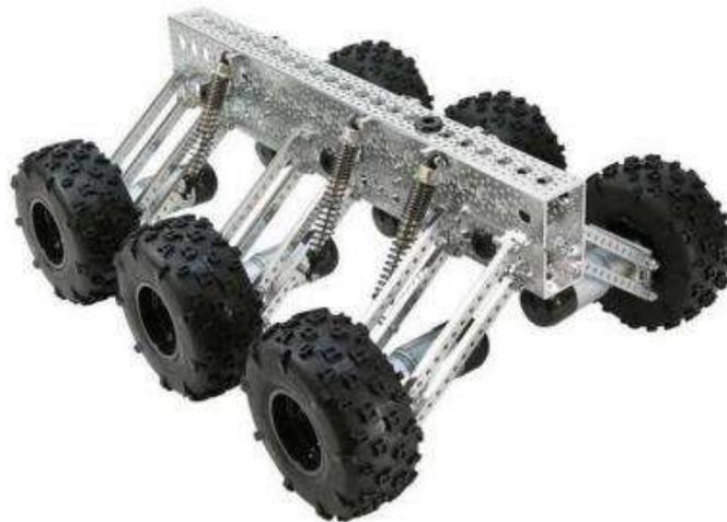
**Figura 60. Sistemas de suspensión de ServoCity Products en robot mantis 6WD. Fuente: [25]**
