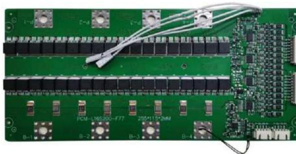
Figura N°0: "Circuito de protección de baterías".
