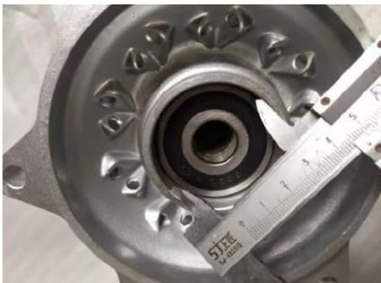
Figura N°12: "Maza de rueda trasera (Izq)".
