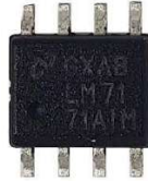
Figura 1.6: Amplificador Operacional LM7171 (SOIC-8)
