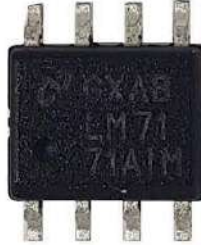
Figura 2.15: Amplificador Operacional LM7171 (SOIC-8)
