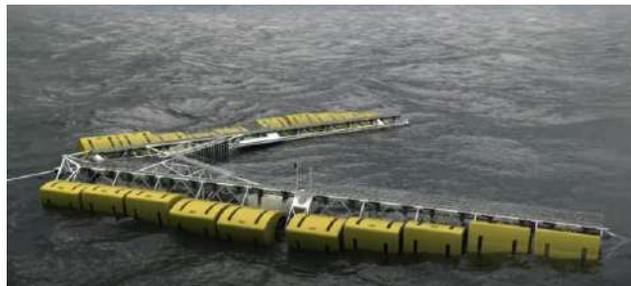
La forma del convertidor permite regular la entrada de energía de las olas y reducir el impacto en condiciones climáticas adversas. Cada rotor transmite la energía a un eje común, conectado al generador. Permitiendo una generación uniforme a lo largo de la duración de la ola.
