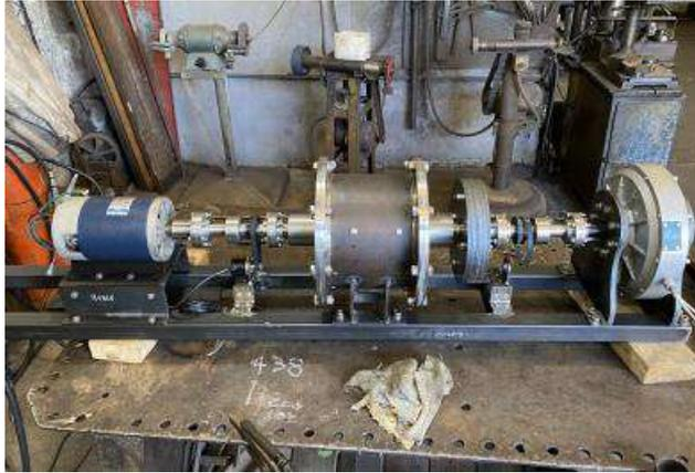
En esta etapa se busca poder verificar experimentalmente los resultados obtenidos en la simulación computacional de los modelos matemáticos realizados para modelar el comportamiento del sistema. Para ello era preciso medir las siguientes variables: Posiciones angulares , velocidades y torques tanto a la entrada como salida del sistema ; así como las tensiones y corrientes de las maquinas eléctricas.
