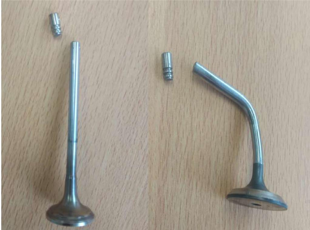
*Figura 7. Falla en el extremo de la válvula.*
