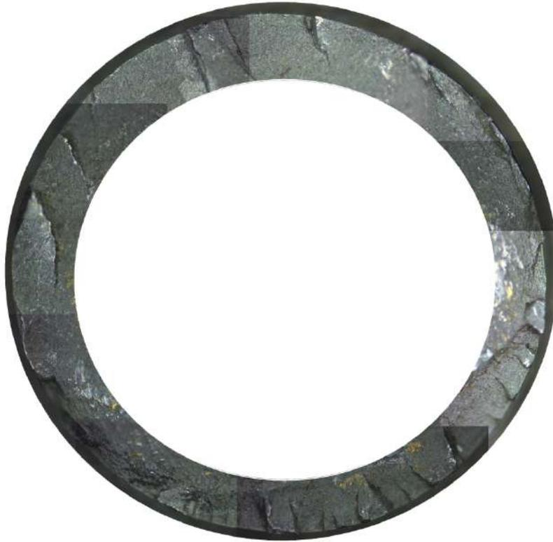
*Figura 68. Perímetro superficie válvula admisión*
