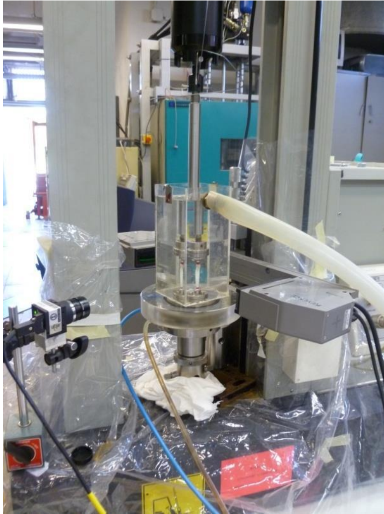
Figura 4.6. Equipamiento utilizado para los ensayos de presión-diámetro.
