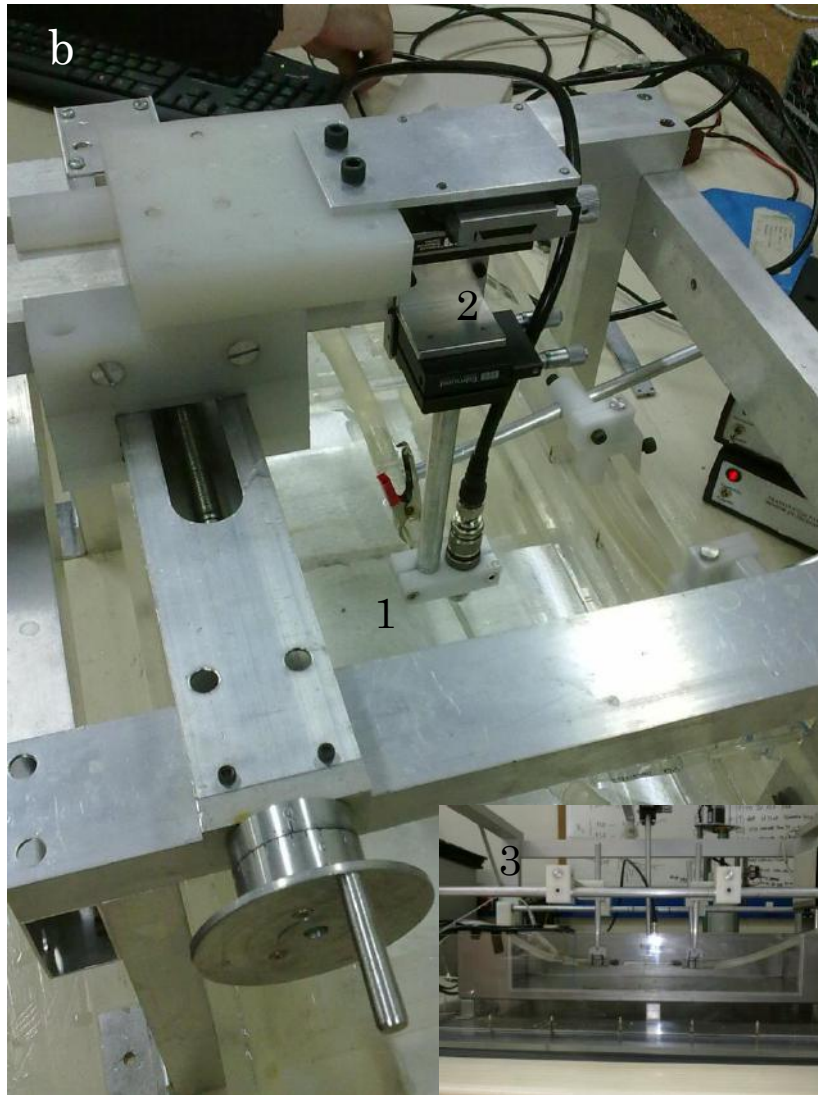
Figura 4.4. a) Esquema del montaje experimental usado (adaptado de Falasco, 2005). b) Fotografía del montaje utilizado para medir espesores mediante sistema A-scan: 1) reservorio de líquido, 2) sistema de posicionamiento gradual mecánico, y 3) muestra colocada en el sistema de posicionamiento durante la medición del espesor.
