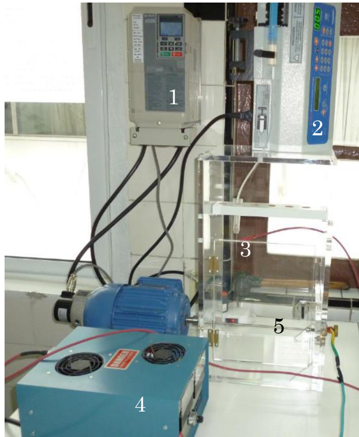
Figura 2.1. Equipo de electrohilado con colector rotatorio. 1) Controlador de velocidad del mandril, 2) bomba de infusión, 3) boquilla, 4) fuente de alta tensión y 5) mandril rotatorio.
