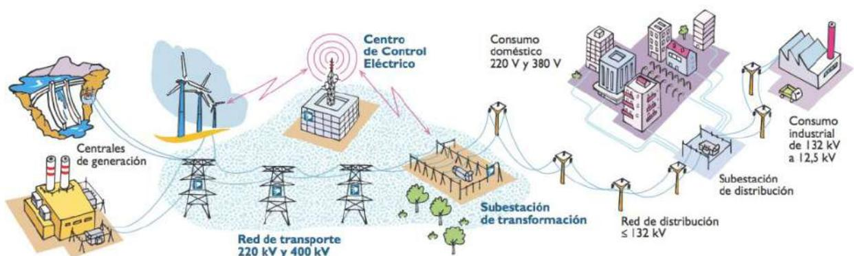
Figura 1-1. Esquema de una Red Eléctrica Convencional.
