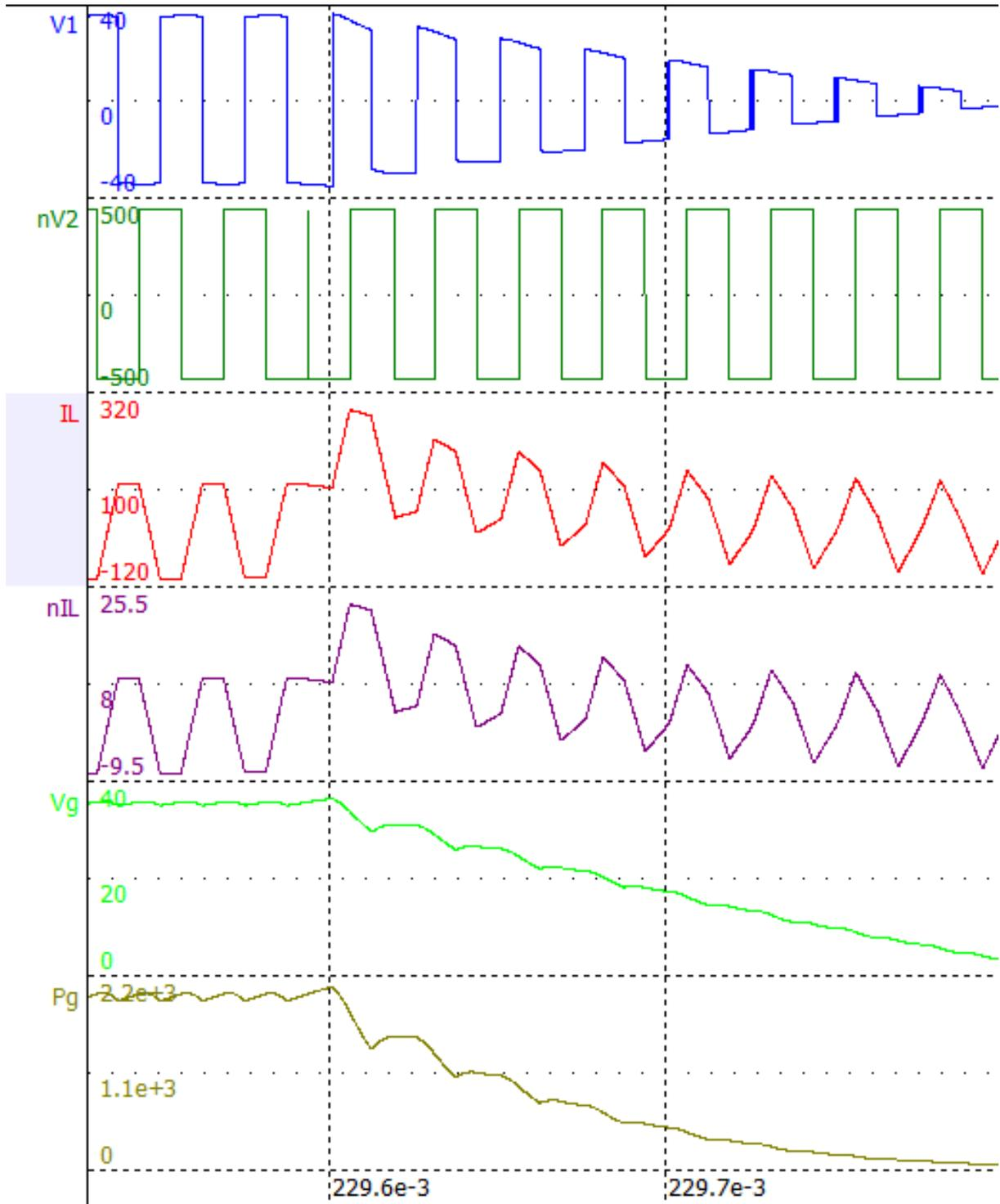
Figura 4.65– Simulación 4: inversión de potencia, carga en la entrada, acercamiento 1.
