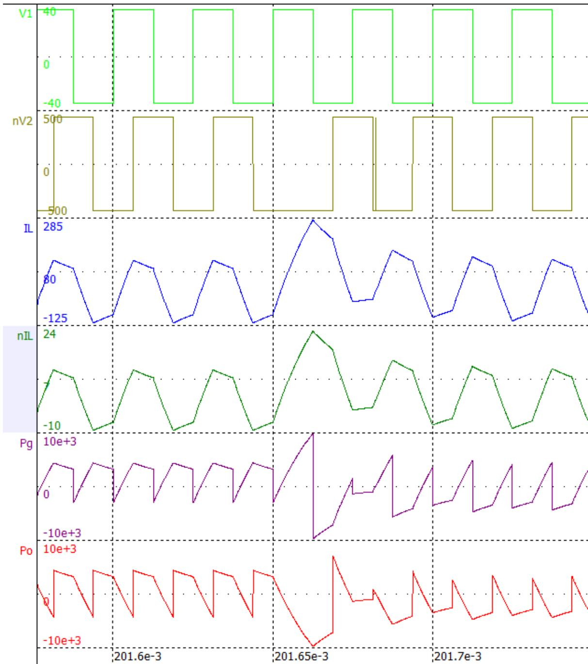
Figura 4.54– Simulación 4: inversión de potencia, sin carga, acercamiento.
