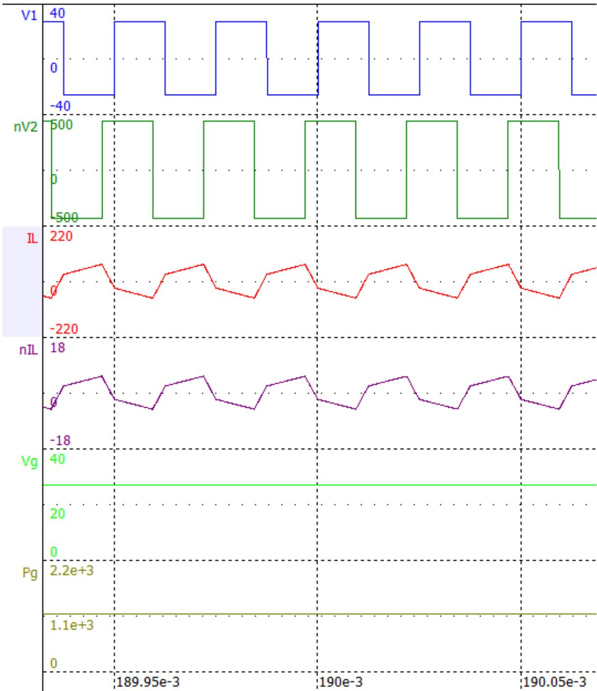
Figura 4.63– Simulación 4: cambio de desfasaje de 0.5 a 0.25, carga en la entrada, acercamiento 2.
