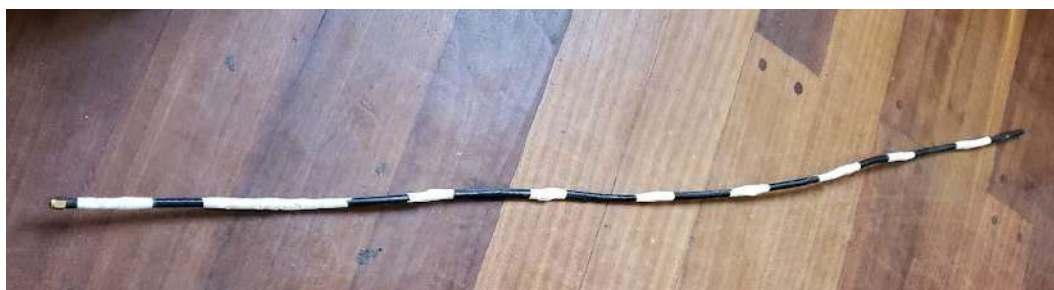
Figura A.9: Foto de la antena colineal finalizada
