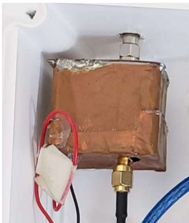
Figura A.42: Foto del Shield instalado
