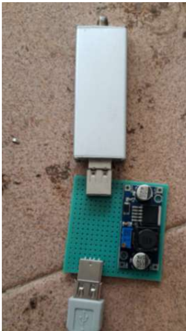
Figura A.43: Foto de la primera solución propuesta para la derivación de energía y datos por USB
