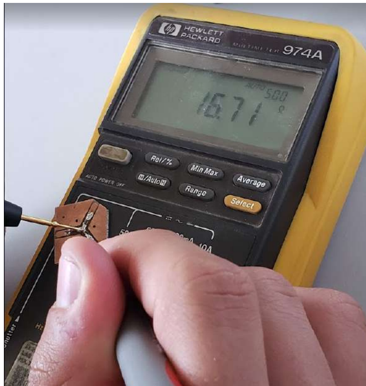
Figura A.49: Foto de la medición de la resistencia de una las ramas del combinador
