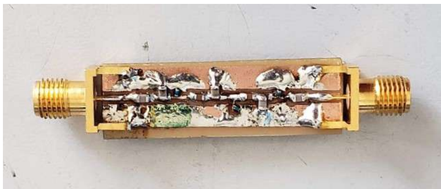
Figura A.32: Foto del filtro de 131.725 MHz construido y soldado
