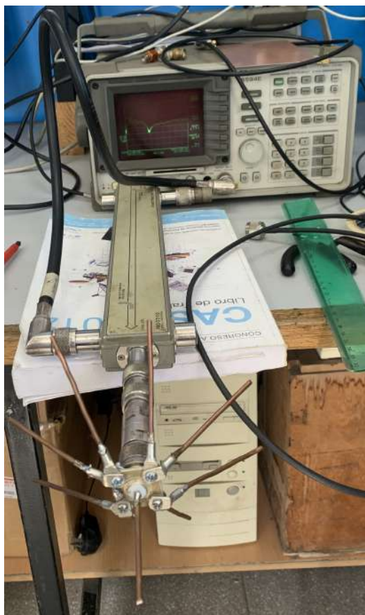
Figura A.15: Banco de medición para la antena spider . Analizador de espectros Hewlett Packard 8594E en conjunto con el acoplador bidireccional Hewlett Packard 778D .
