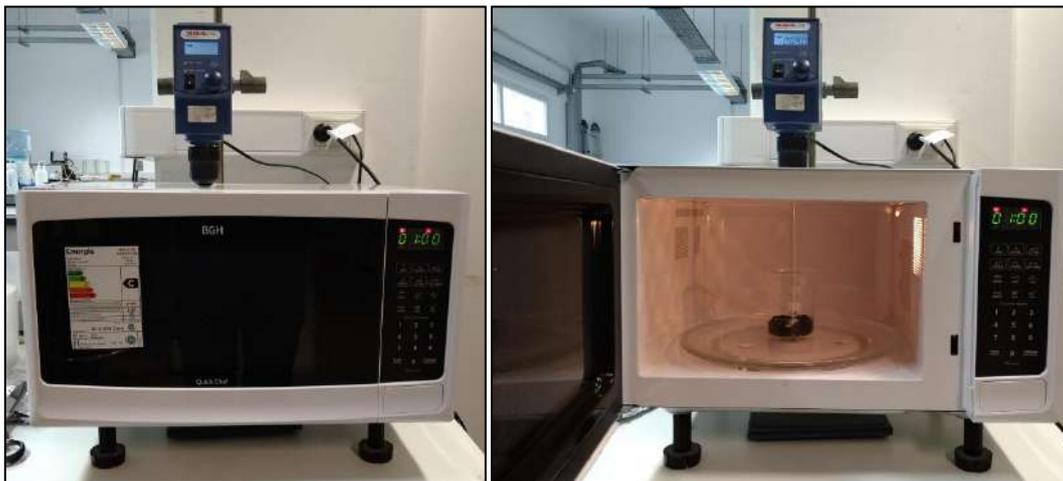
**Figura 3.3.** Microondas doméstico adaptado para realizar ensayos de devulcanización.
