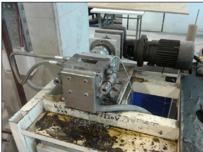
**Figura 3.10.** Mezcladora de doble tornillo tipo *Haake*.
