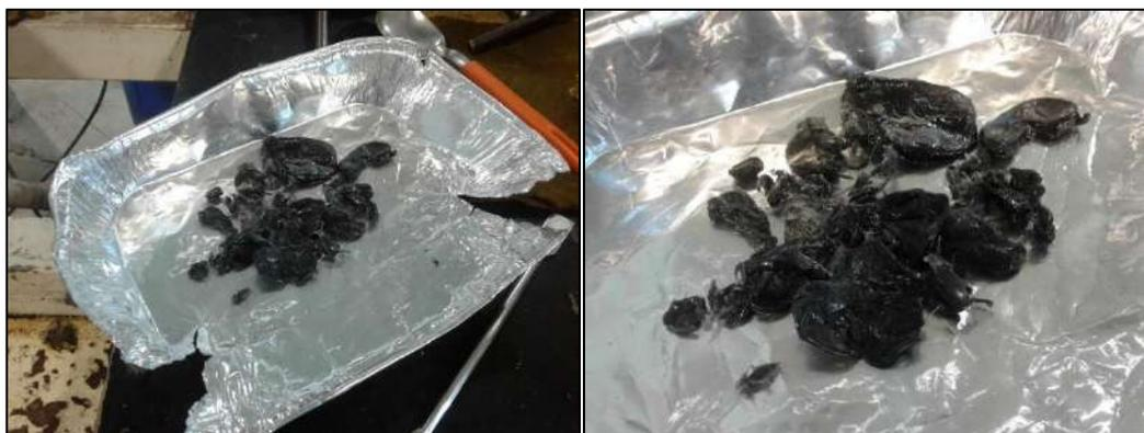
**Figura 3.12.** Material compuesto de LLDPE/PP/Terpólímero/GTR obtenido en la mezcladora.
