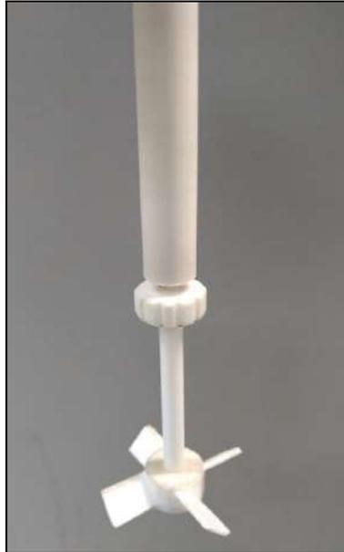
**Figura 3.2.** Varilla agitadora de teflón.
