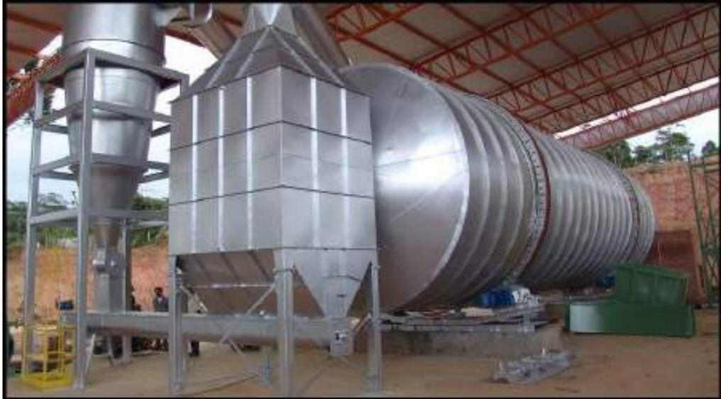
Figura 20: secador rotatorio Lippel
