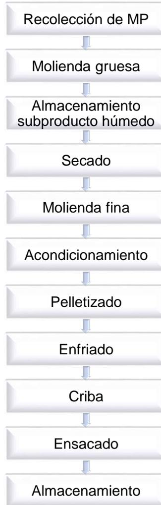
Figura 16: Proceso de peletización. Elaboración propia
