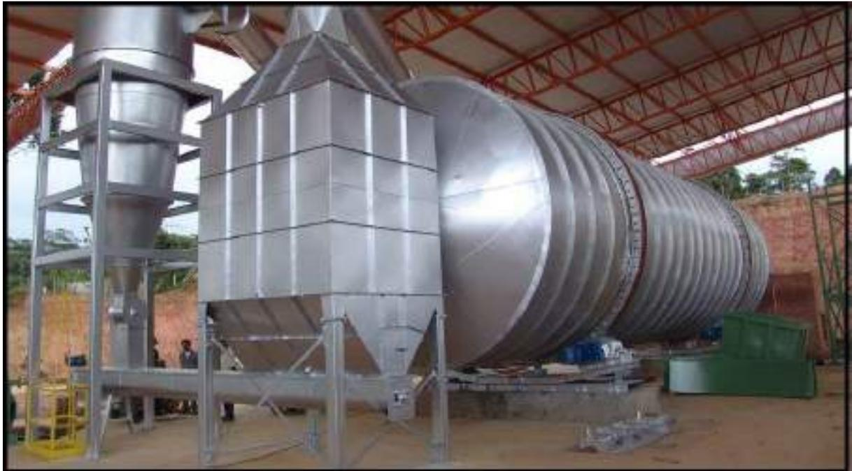
Figura 32: secador rotatorio Lippel
