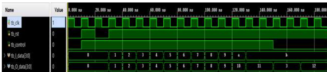
FIGURA 4.5: Formas de onda para codificador Reed Solomon.
