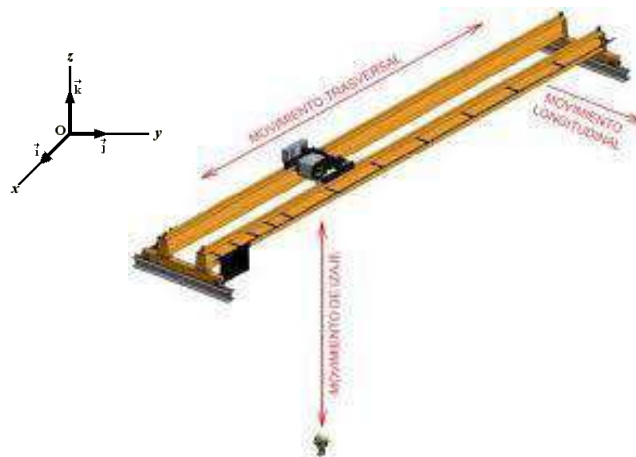
Figura 2.1: Puente grúa birriel y componentes
