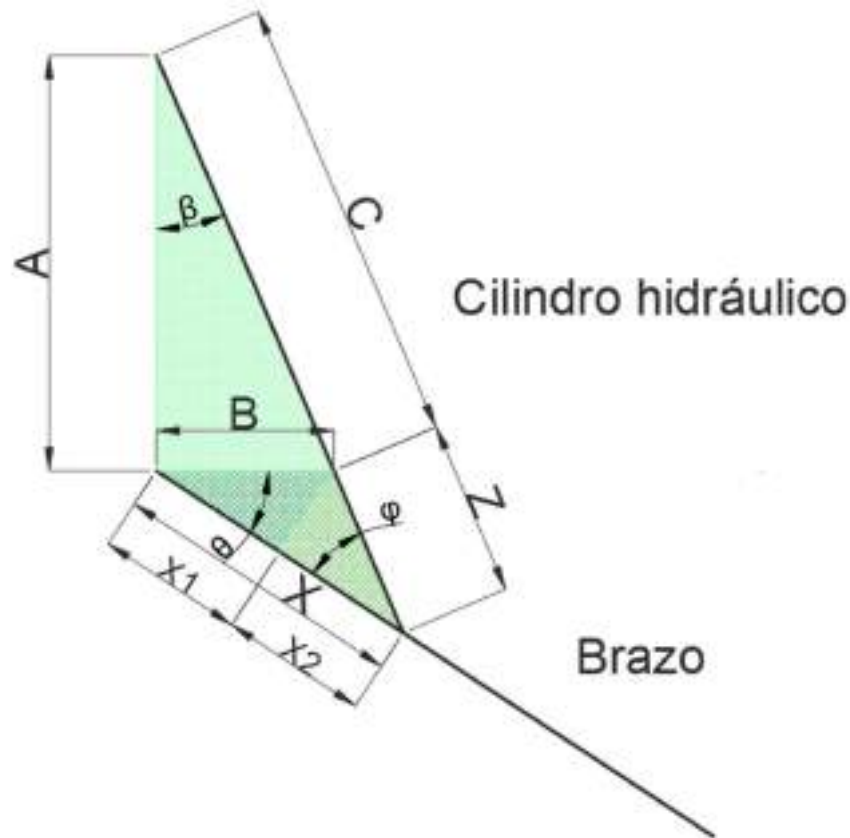
Figura 4.3.1.1. Medidas geométricas entre la pared, el cilindro y brazo. Fuente: [Elaboración propia].
