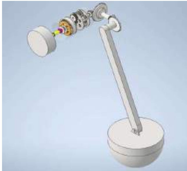
Figura 2.1.1. Sistema mecánico de energía undimotriz. Fuente: [3].
