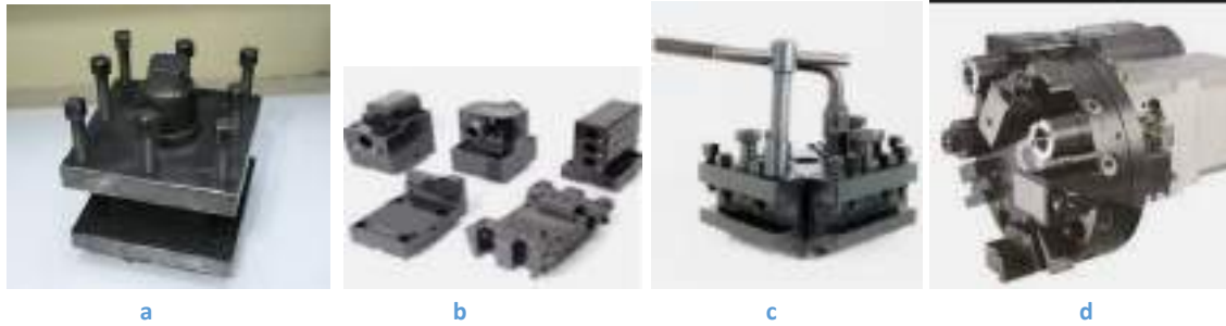
Fig. 63. a) Torreta giratoria convencional. b) Torres portaherramienta individuales. c) Torreta de cambio rápido tipo "Peyal". d) Torreta automática.
