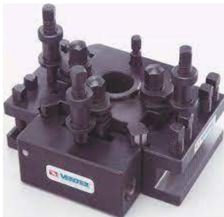
Fig. 69. Torre de cambio rápido tipo "Peyal" marca Vertex.
