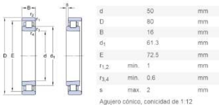
Fig. 51. Dimensiones del rodamiento N 1010 KTN/SP
