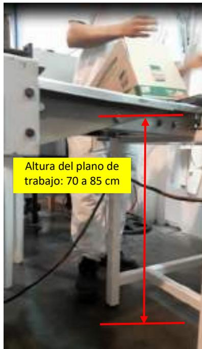
Foto 3.13: Altura del plano de trabajo - Estuchador. Fuente: Propia
