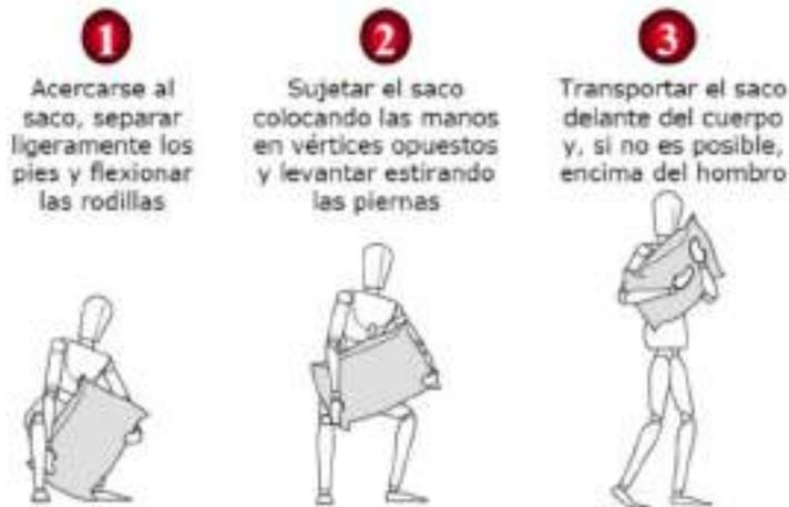
Figura 3: Manipulación de Bolsas. Fuente: <https://studylib.es/doc/6327068/manejo-manual-de-cargas>.
