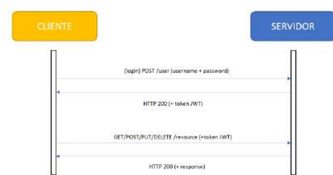
Figura 86: Flujo entre un cliente y un servidor que implementa el protocolo REST. Adaptado de Castillo Rodríguez [34].
