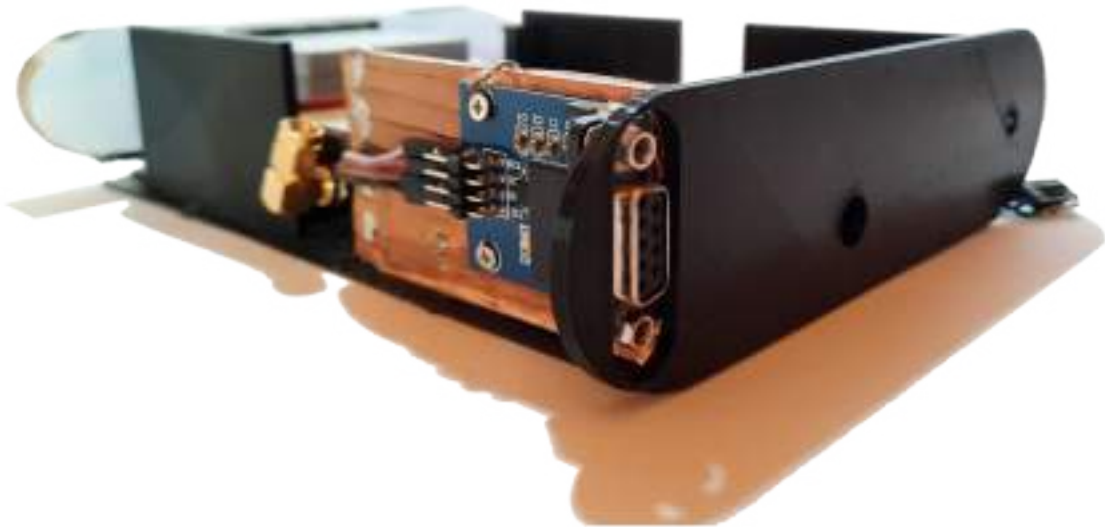
Figura F.6: Z-UHF Blindaje electromagnético
