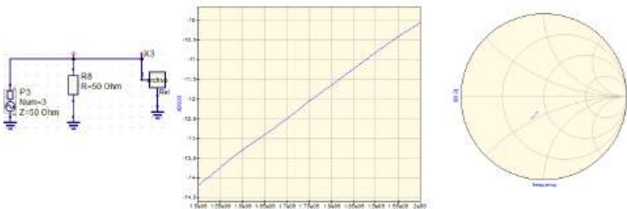
Figura 3.14: Simulación impedancia de entrada, AD8302 con 50Ω
