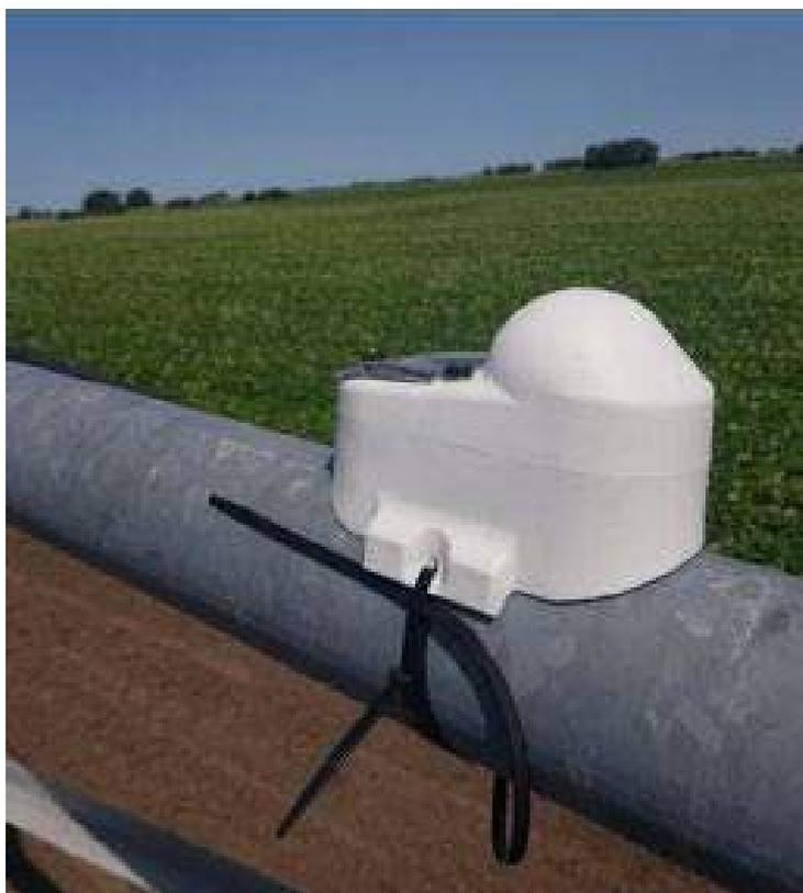
Figura 6: Dispositivo con sensor de posición. Fuente: Empresa
