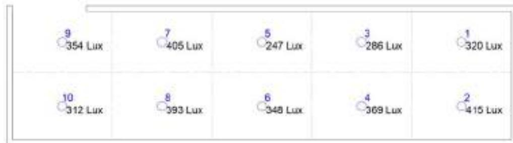
**Figura XXXII - Puntos de medición de la iluminación general en el sector de acabado superficial - Fuente: Propia**
