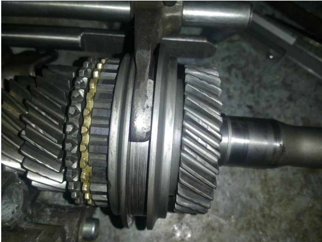
Figura 6.2.11 – Manguito sincronizador desplazado para acoplar la 4 ta
