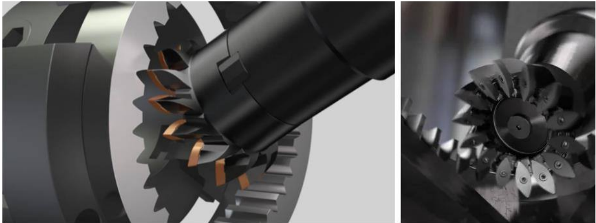
Figura 7.5.10 – Proceso Power skiving
