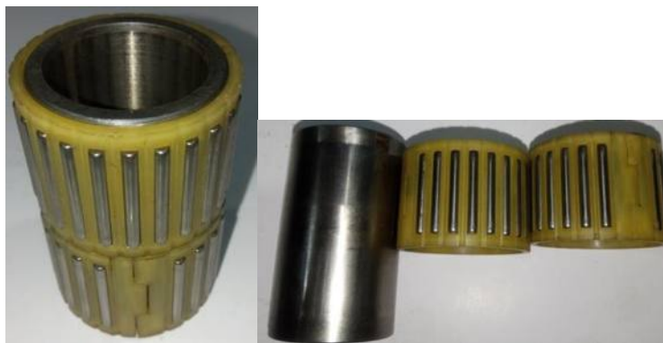
Figura 6.3.6 - Rodamientos de agujas, engranaje de 5°. Ambos trabajan sobre una única pista (6)
