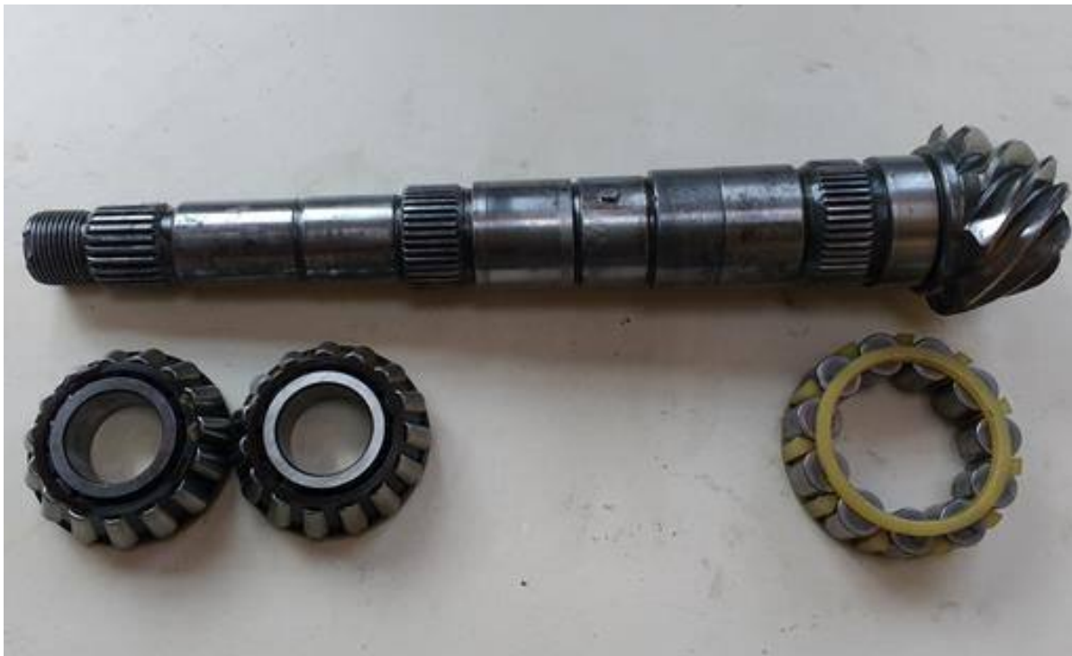
Figura 6.1.15 - Árbol del piñón con rodamientos. (Vista general)
