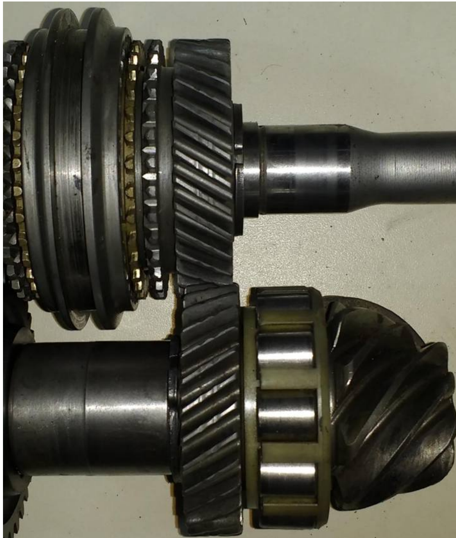
Figura 6.2.10 – Árboles enfrentados en los engranajes de 4 ta
