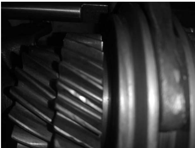
Figura 6.2.9 – Manguito sincronizador desplazado para acoplar la 3 era
