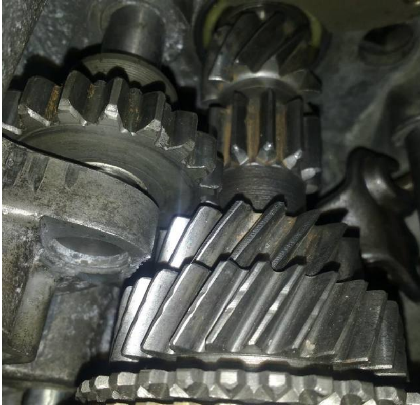
Figura 6.2.8 – Árbol primario dentro de la carcasa (vista eng. 2 da y 3 era conductores)
