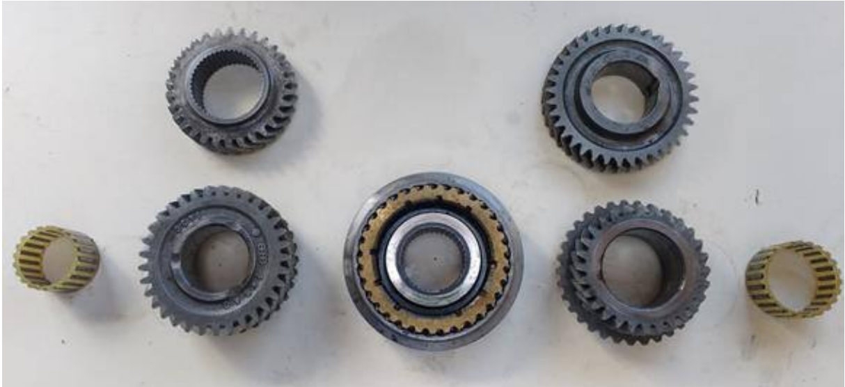
Figura 6.1.26 - Engranajes 3º y 4º. (Vista en explosión general)
