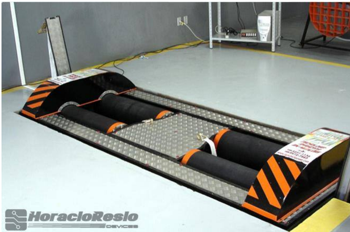
Figura 10.1.1 – Banco de pruebas a rodillo
