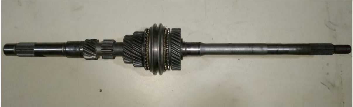
Figura 6.1.16 – Árbol primario con engranajes. (Vista general)
