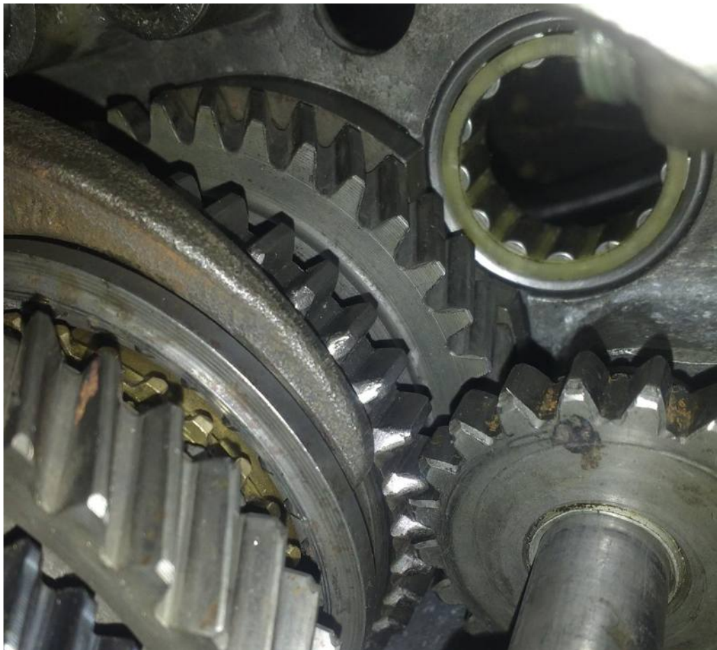
Figura 6.2.2 – Árbol del piñón dentro de la carcasa.
