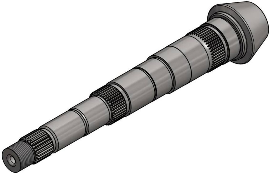
Figura 3.4.6 – Esquema Árbol del piñón
