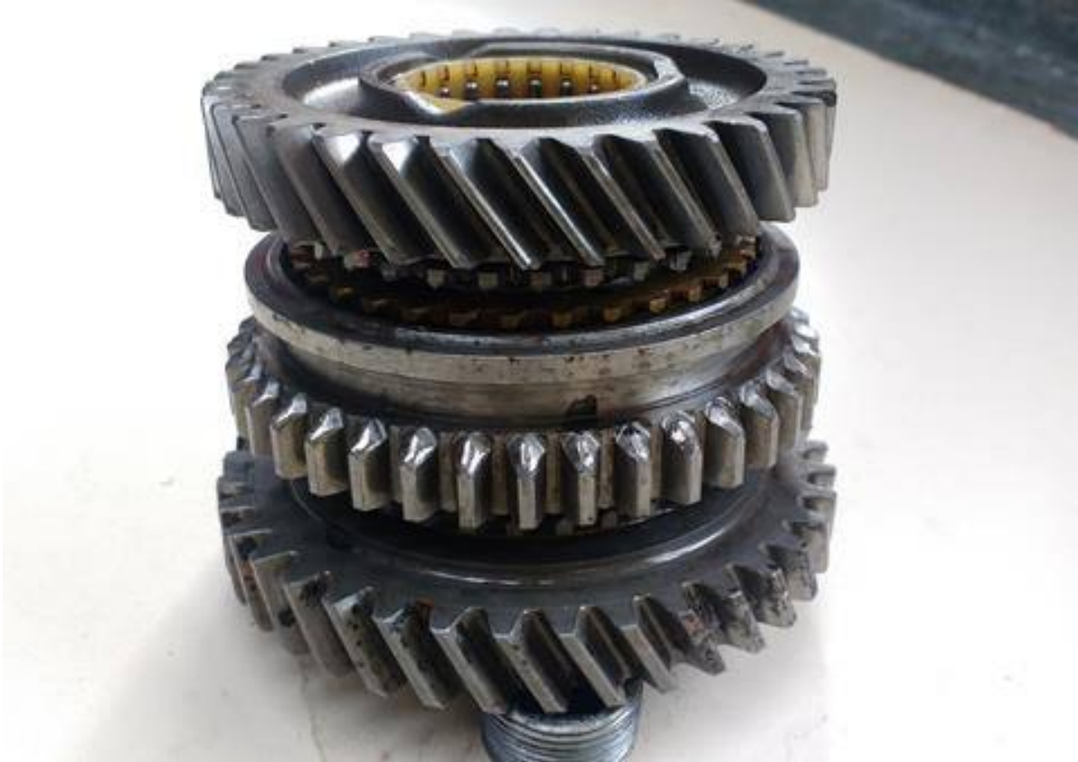
Figura 6.1.19 - Engranajes conducidos 1º, 2º y reversa. (Vista general)
