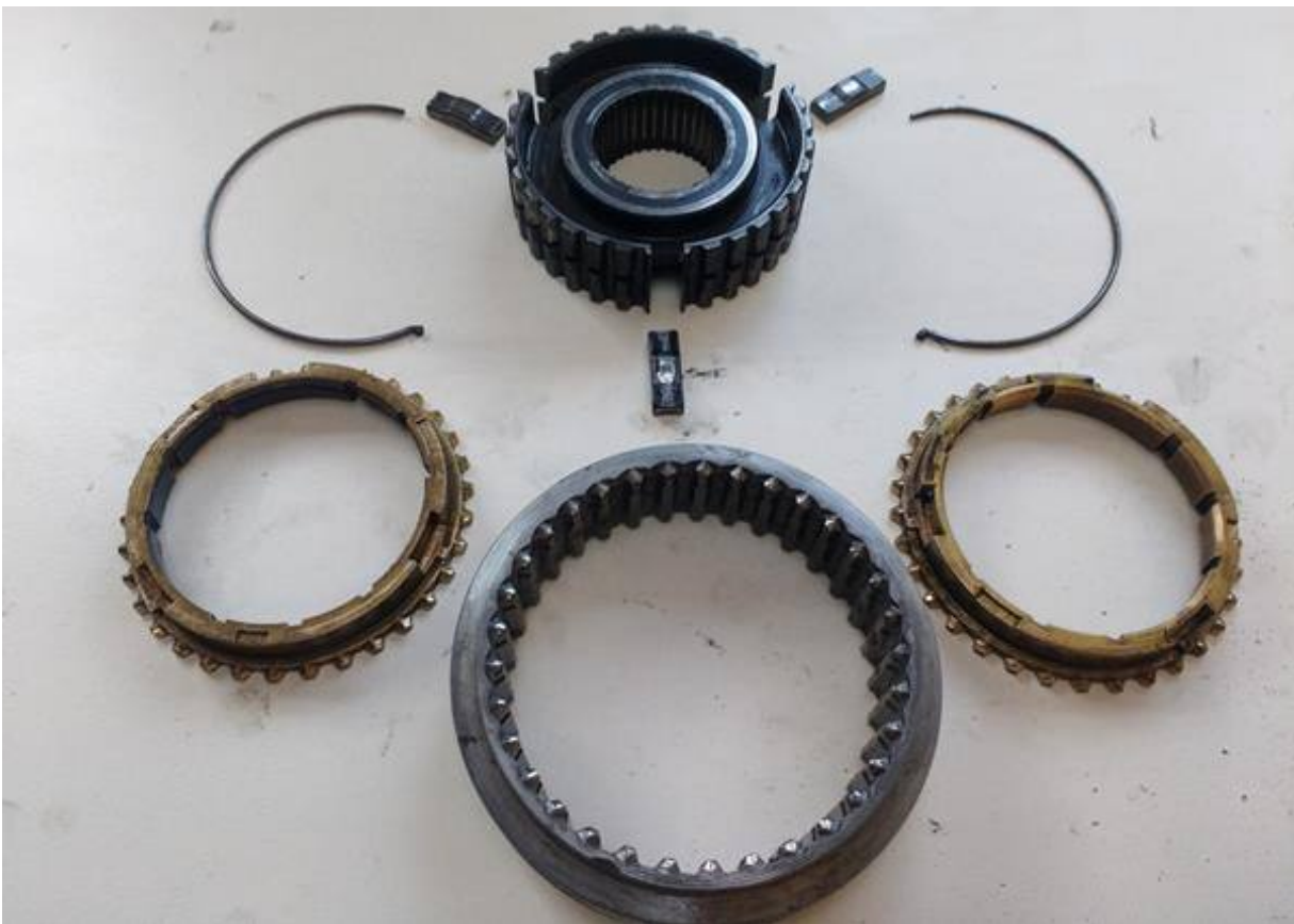
Figura 6.1.29 - Sincronizado 3º y 4º. (Vista en explosión general)
