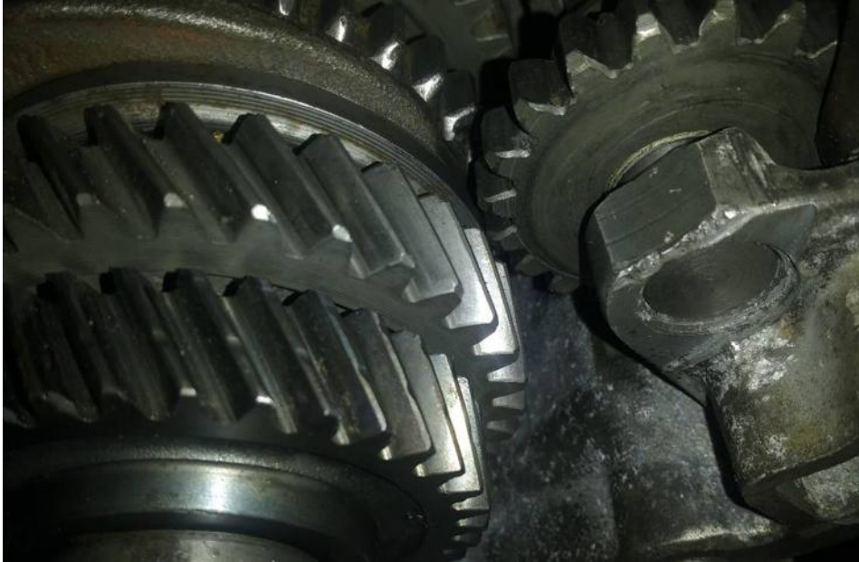
Figura 6.2.5 – Engranaje de segunda engranado (vista 1)
