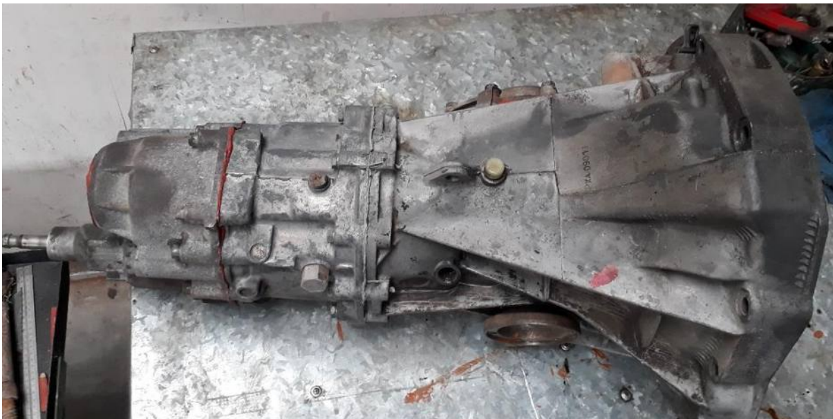
Figura 6.1.7 - Caja de cambios. (Vista lado superior)
