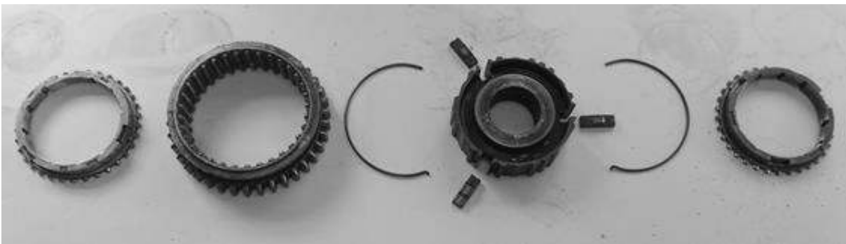
Figura 6.1.21 - Sincronizado 1º y 2º. (Vista en explosión general)
