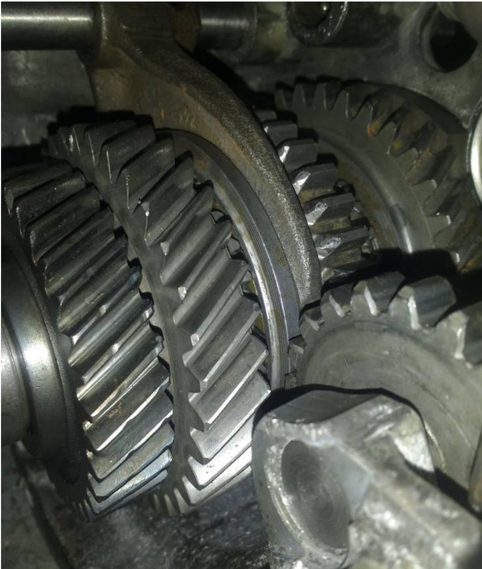
Figura 6.2.6 – Engranaje de segunda engranado (vista 2)
