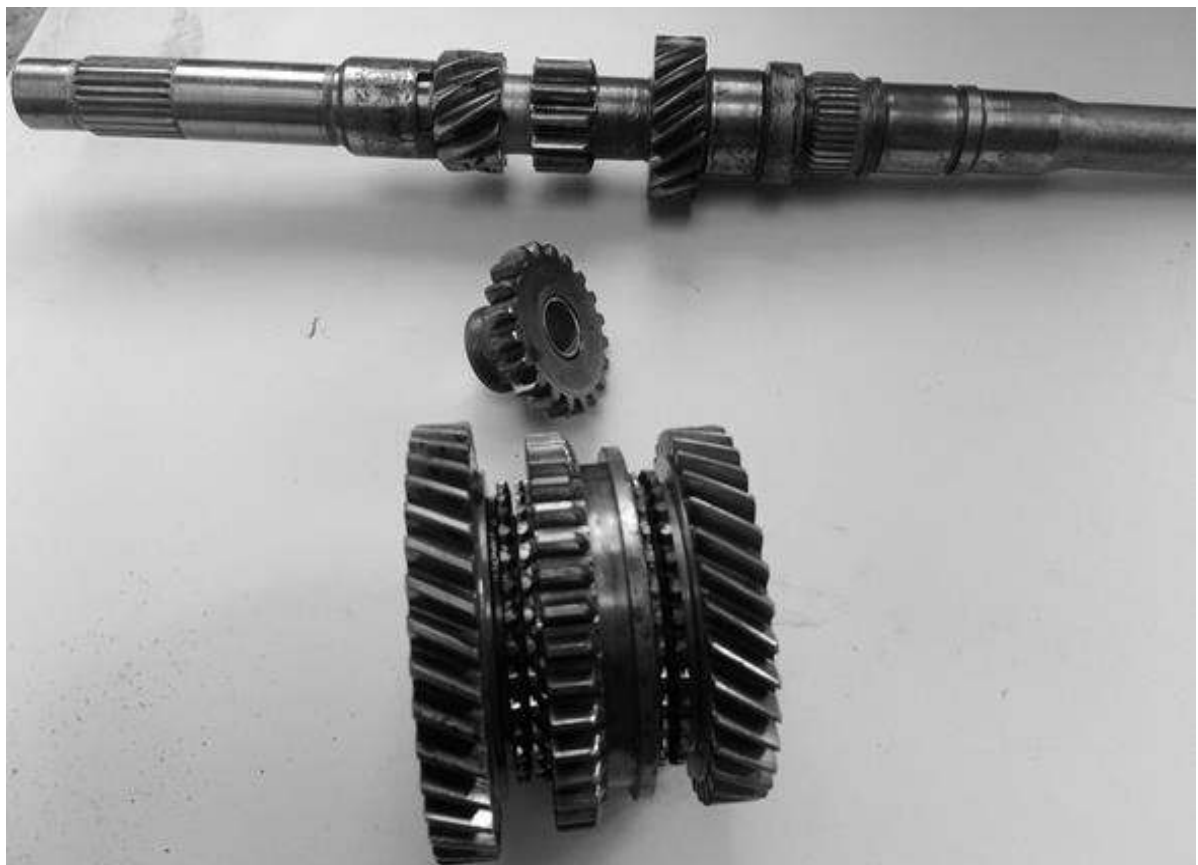
Figura 6.1.18 - Árbol primario y engranajes de 1º, 2º y reversa. (Vista general)
