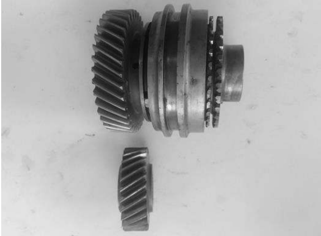
Figura 6.1.30 - Engranajes de 5°. (Vista general)
