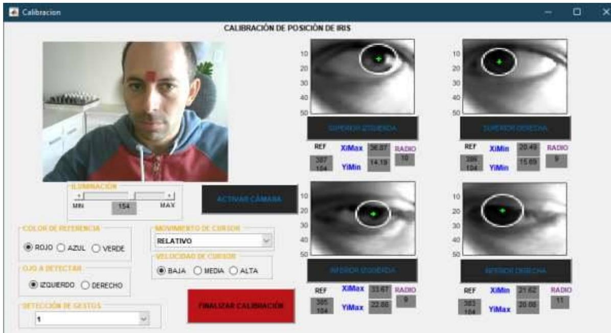
Figura 3.7 Ventana de Calibración de posición de iris.
