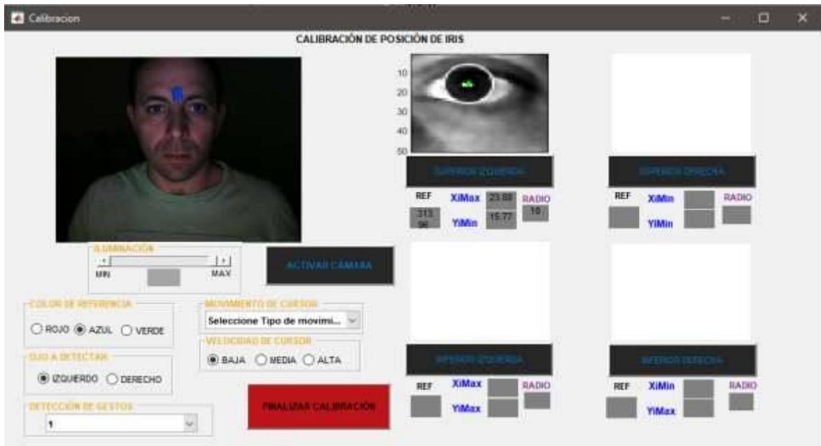
Figura 4.9 Detección exitosa de iris con referencia en color azul en idénticas condiciones de iluminación.
