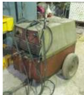
Figura 24: Soldadora eléctrica Fuente: Elaboración propia
