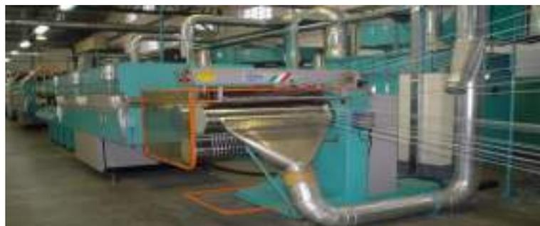
Foto III. Línea de extrusión parte posterior -Fuente: propia
