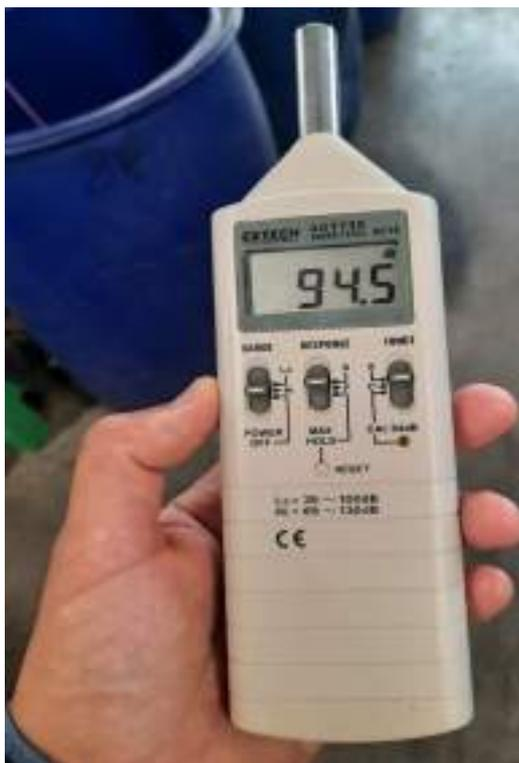
Figura V. Medición de nivel sonoro en el área de armado pallets-Fuente: Propia
