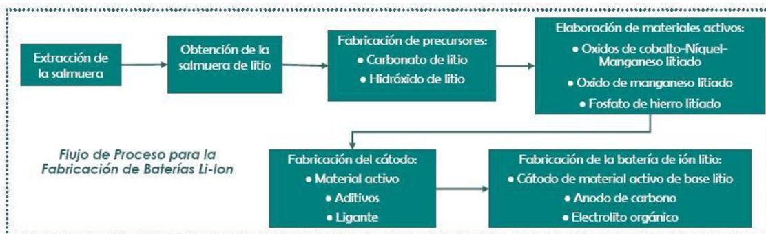
Fig. 22 – Flujo de proceso para la fabricación de baterías de ión-litio
