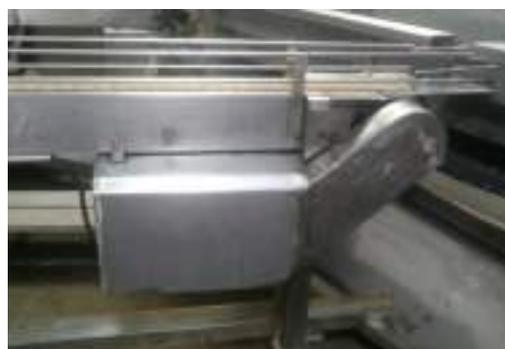
Figura XIII. Resguardo fijo para eje de transmisión de movimiento. Fuente: Propia.
