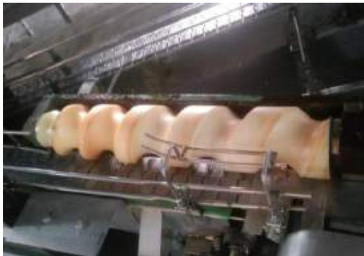
Figura XV. Tornillo transportador de latas con cobertura. Fuente: Propia.
