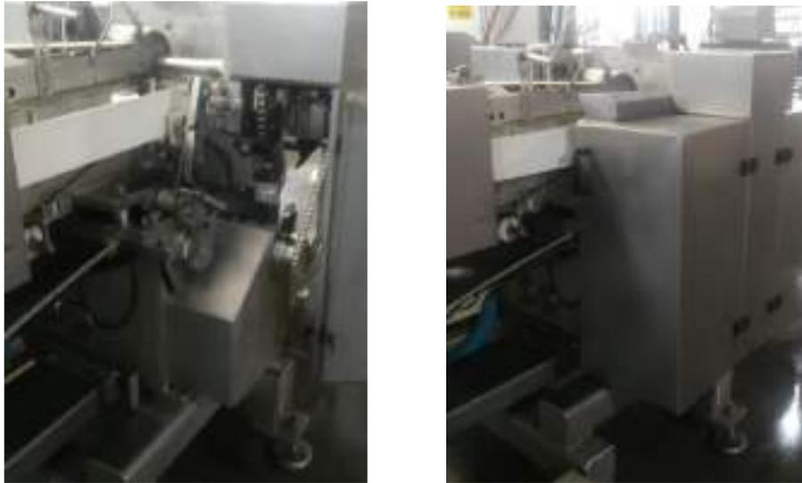
Figura XI b. Protector móvil para ejes de transmisión en máquina envasadora. Fuente: Propia.
