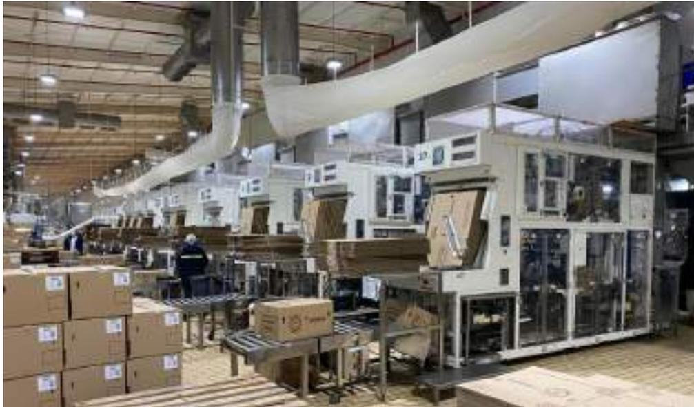
Imagen 1. Máquinas armadoras de cajas y colocadoras de paquetes completamente autónomas.
