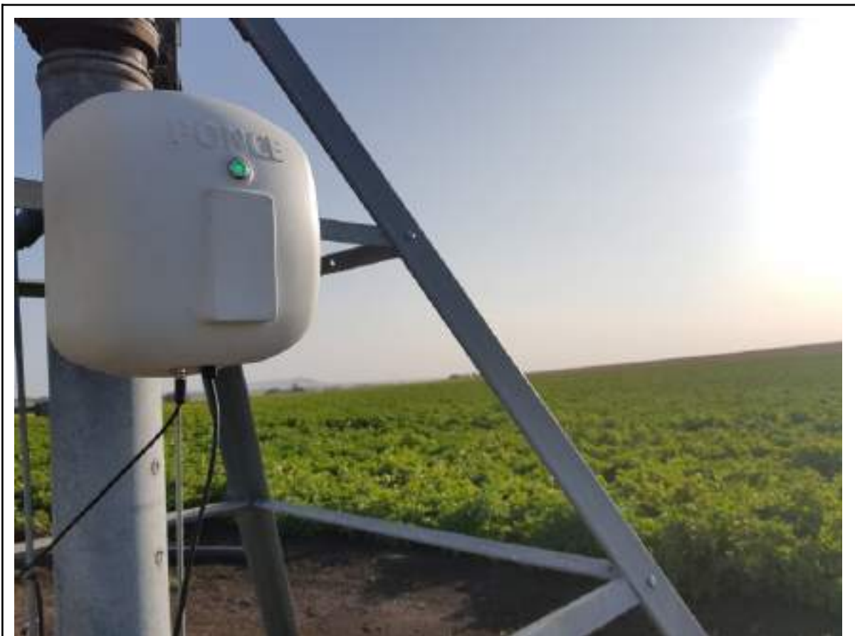
Figura 3. Gateway de la empresa instalado en un equipo de riego.[4]
