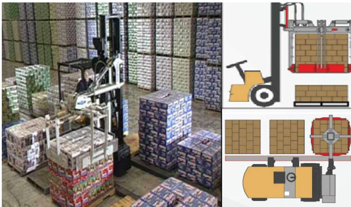
Figura N°23: Equipos Layer Picker . A la izquierda Brazo telescópico (Tygard), derecha superior Frontal, derecha inferior Lateral
